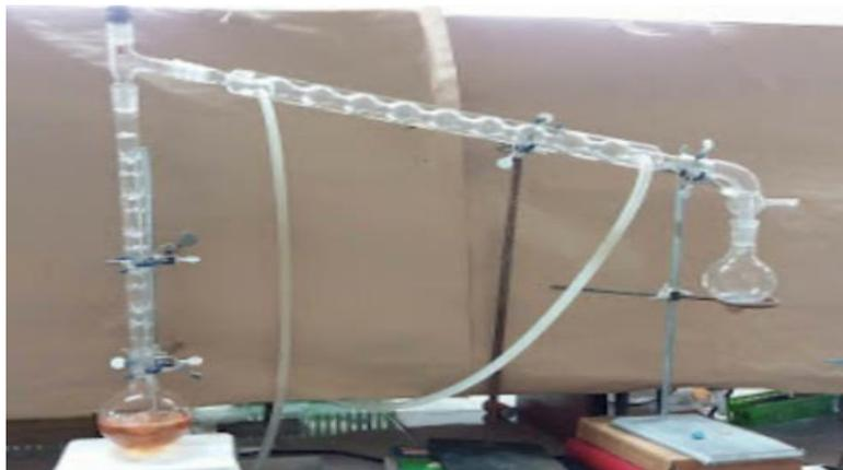
**Figura N°18. Destilador fraccionado utilizado para el grado alcohólico.**
