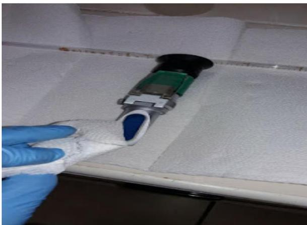
**Figura N°16. Brixómetro utilizado**
