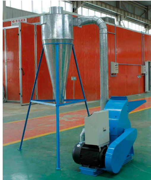
ILUSTRACIÓN 35: MOLINO DE MARTILLO
