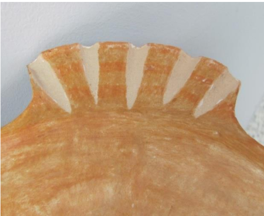
d) Pieza cerámica de la que se aplicó la tonalidad naranja por falta de concentración de temperatura durante la quema.
