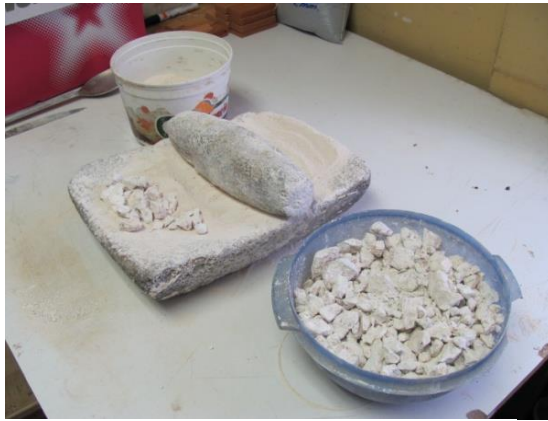
Fig. 56. Detalle de la piedra de moler y la obtención del caolín triturado. Fuente: Equipo Investigador.
