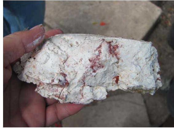
Fig. 50. Detalle del caolín con partículas de hierro depositado entre la arcilla. Fuente: Equipo Investigador.
