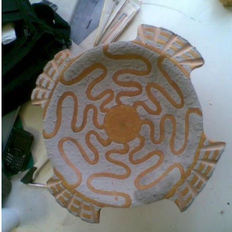
d) Detalle de la aplicación de la pieza dentro del horno alcalino ya finalizada. En esta aplicación para la segunda de la pieza se puede ver algo de pérdida de la tonalidad la humedad del material similar o característica de la cerámica Izalco-Usulután.
