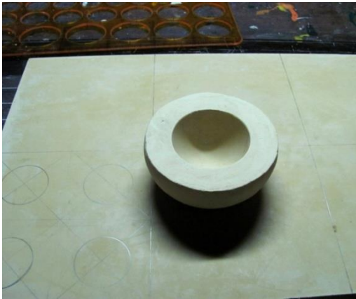
Fig. 113. Se dibuja y divide la placa en 6 partes iguales para posteriormente cortarla. Fuente: Equipo investigador.
