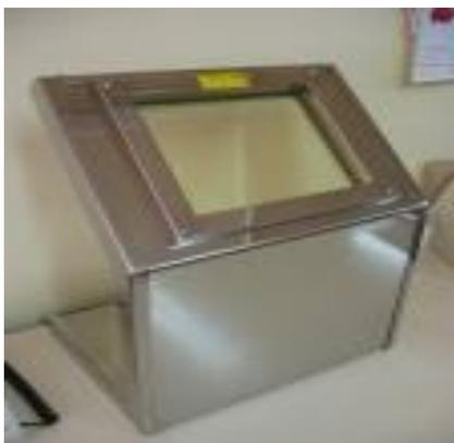
Mampara plomada: protege el pecho y la cabeza de la radiación durante la manipulación de material radiactivo gracias su construcción en plomo y cristal plomado.
