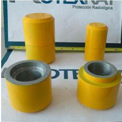
Contenedor plomado para viales: la función principal del contenedor blindado es almacenar al radioisótopo y atenuar la radiación que este emita y están fabricados aproximadamente de 1 pulgada de plomo.
