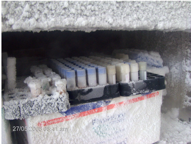
Figura A9. Muestras de suero canino debidamente identificado, almacenado en microviales de 3 ml.
