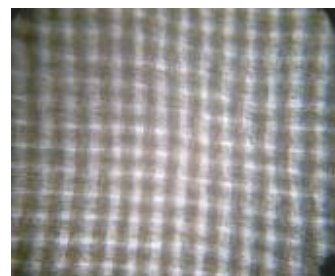
Figura N° 15 Vista microscópica de los poros de la bolsa de degradación.
