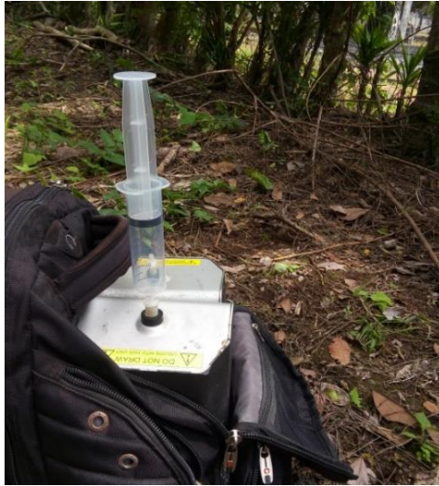
Figura 19. Determinación de Hg / H 2 S en equipos Jerome.
