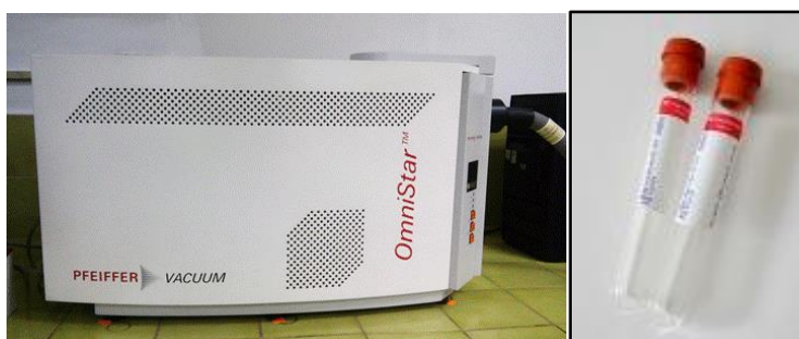
Figura 21. Espectrómetro de masas cuadrupolar, en recuadro se muestra los vacutainer para el traslado y almacenamiento de muestras.
