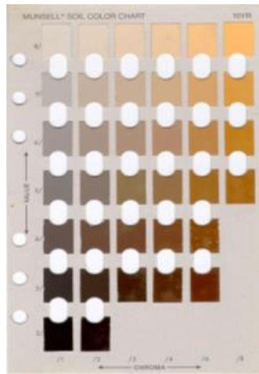
Figura 5. Tabla de colores Munsell, con el tono más utilizado para identificar suelos.
