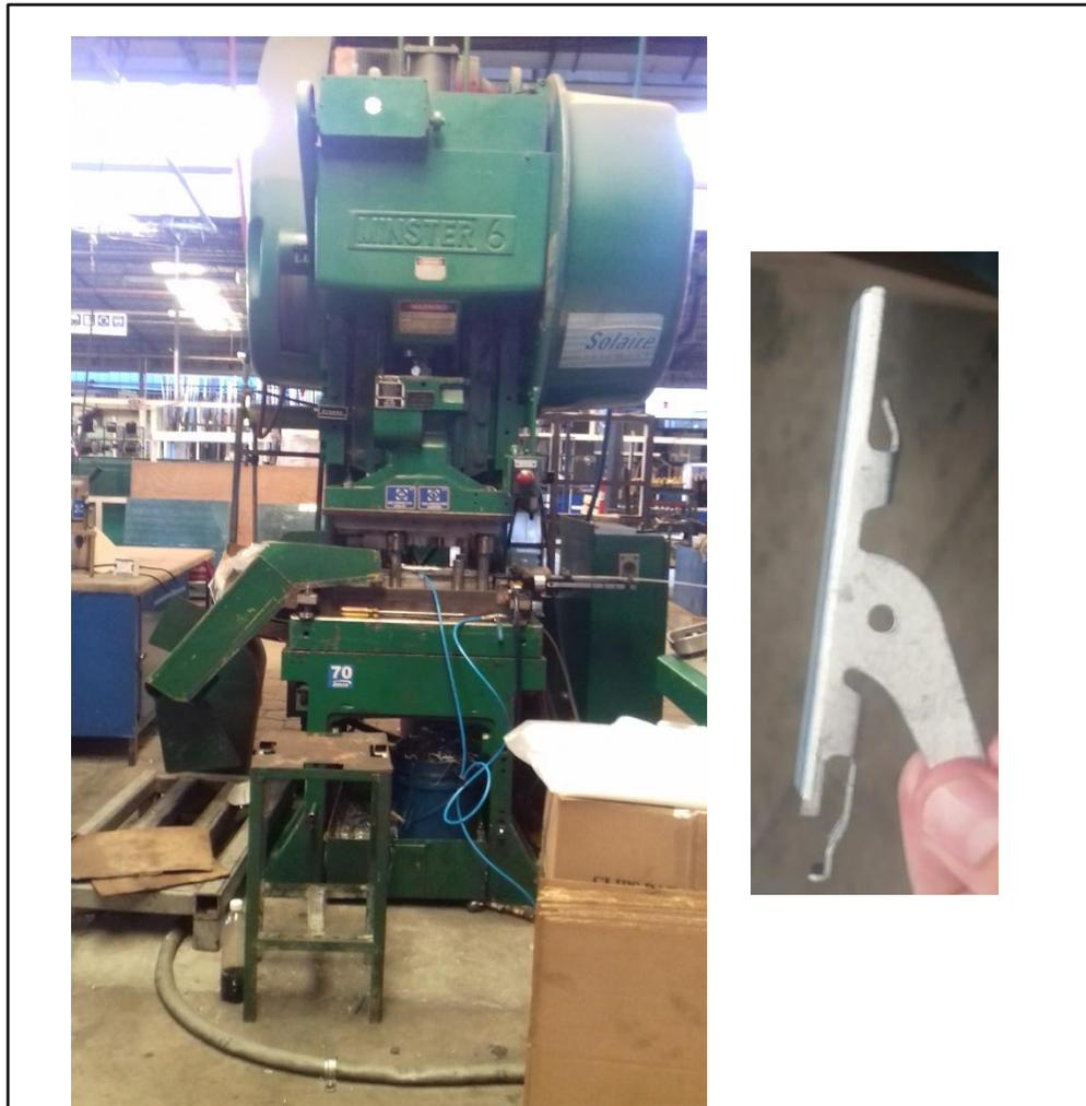
**Ilustración 1** Prensa Troqueladora para clips de aluminio de 4'' y 6'' (izquierda). Clip de aluminio de 4'' (derecha)
