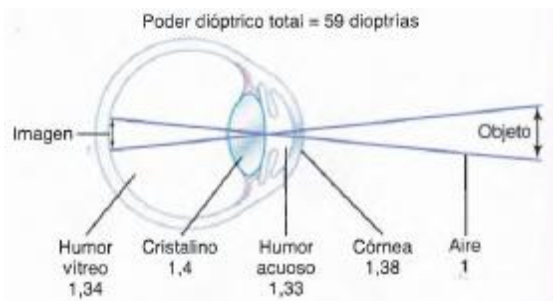
Figura 9 El ojo como una cámara. Los números indican los índices de refracción.
