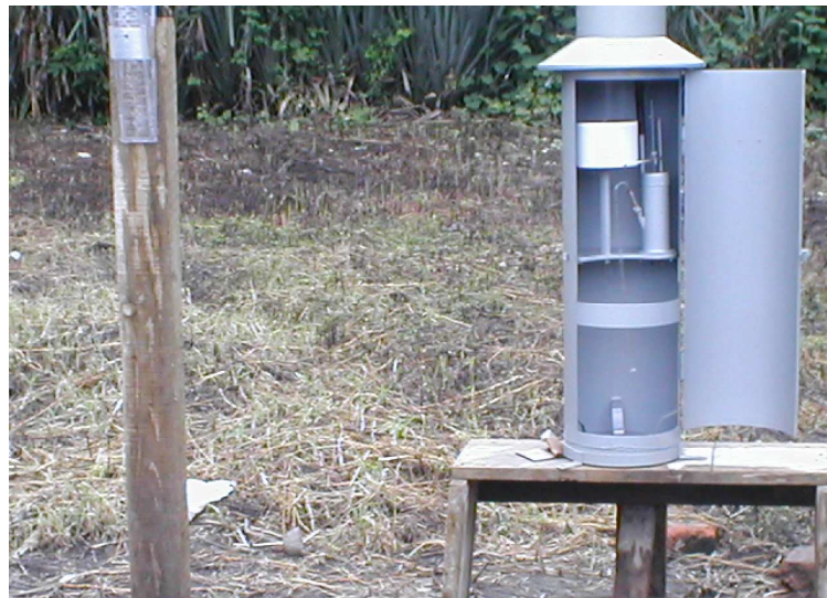
Figura 3: Pluviómetro y pluviógrafo utilizados en la toma de datos de precipitación en la cuenca.
