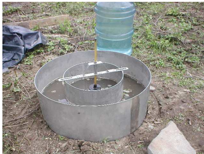
Figura 6: Infiltrómetro utilizado en las pruebas de infiltración realizadas en la cuenca.
