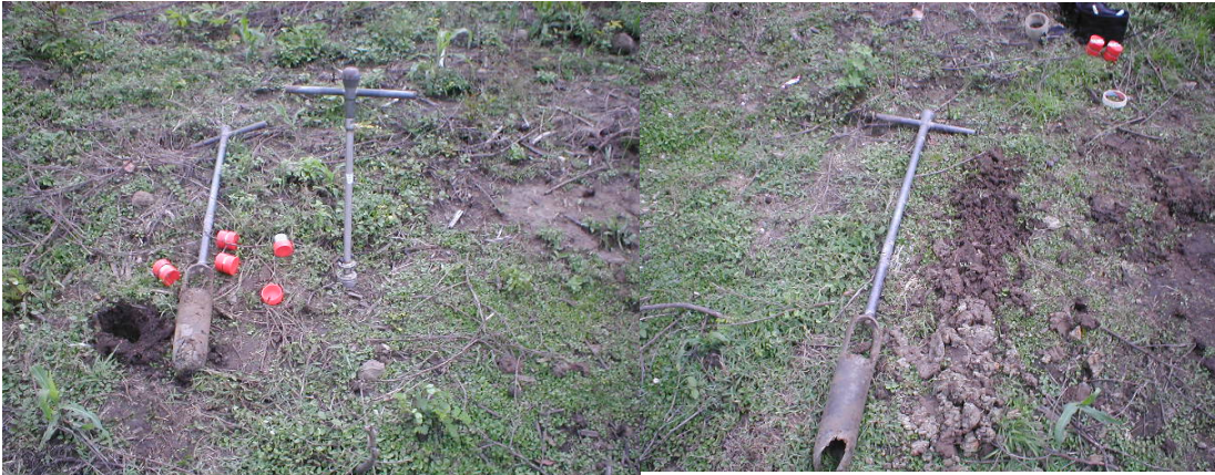
Figura 7: Toma de muestras para realizar el análisis de densidad aparente del suelo en la cuenca.
