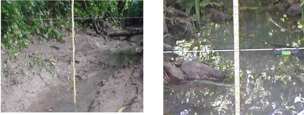
Figura 8 : medición del caudal en una de las subcuencas del Río Paso Hondo.
