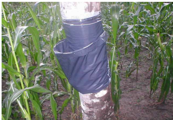
Figura 4: Sistema de recolección de agua en el dosel del árbol para medir el escurrimiento por follaje.
