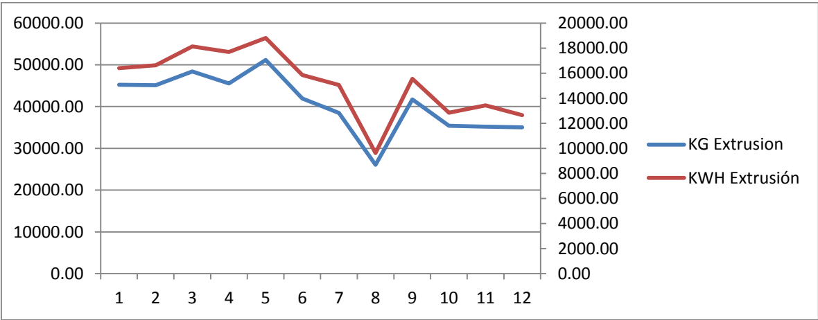
Figura37 Comportamiento del consumo de energía y producción de la extrusora de plástico. [29]
