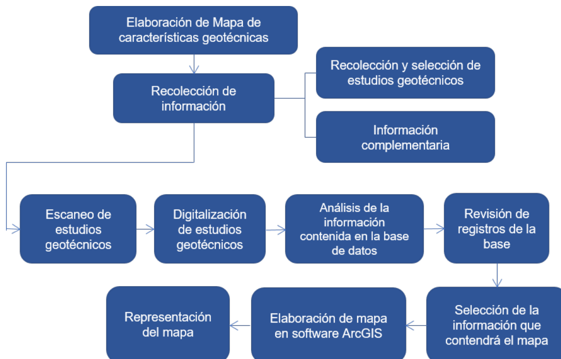
Figura No. 3.3 Esquema de proceso de la elaboración de mapa de características geotécnicas Fuente: autores
