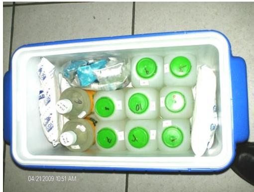
Figura N° 54: Recolección y transporte de muestras mediante el uso de una hielera.
