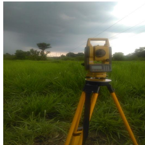
Figura 7.1 Equipo adecuado para el replanteo topográfico (Estación total de doble rebote)
