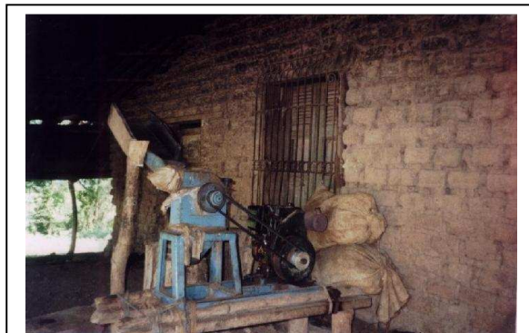
Fig. 23: Picadora utilizada para moler la cáscara.
