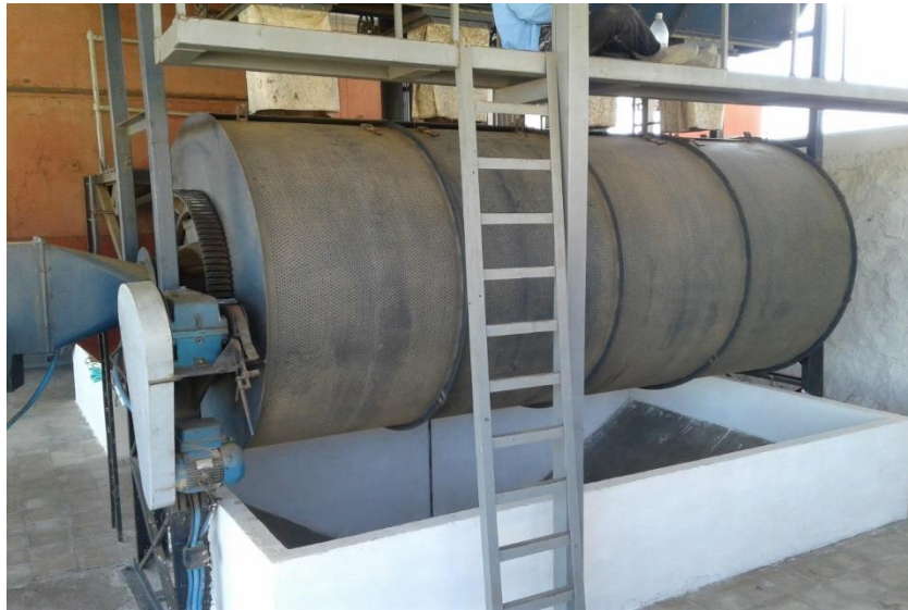
Figura 19. Secador rotativo tipo Guardiola. [Fotografía], secador en beneficio Tecapa, Berlín, Usulután (silo de café). Fuente: Grupo investigador.
