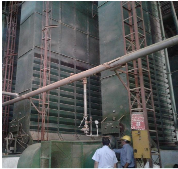
Figura 20. Secador tipo vertical. [Fotografía], Beneficio La Majada, El Salvador. Fuente: Grupo investigador.
