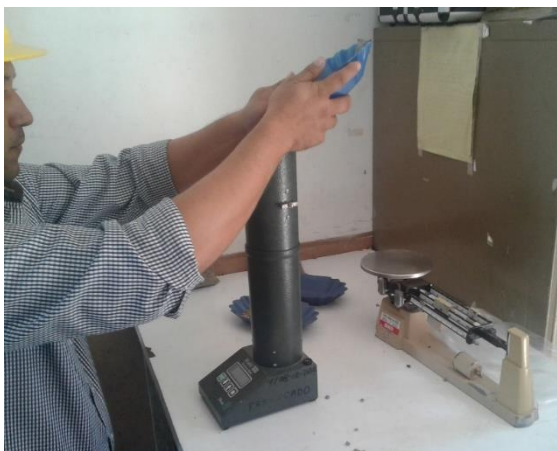
Figura 17. Dispositivo medidor de humedad del grano de café. [Fotografía] Beneficio La Majada, El Salvador. Fuente: Grupo investigador
