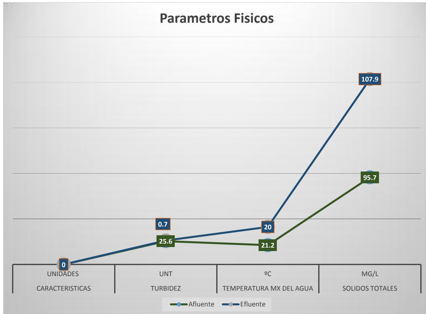
**Grafica 6 Porcentaje de reducción de parámetros físicos del afluente y efluente de la Planta Potabilizadora Tamulasco.**
