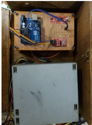
Figura 61. Montaje del circuito y fuente en la caja de madera.
