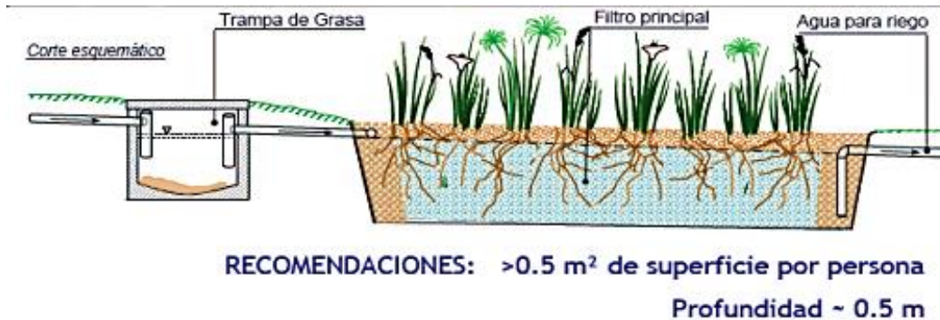
Figura 4.4 Esquema de sistema de biojardinera (NEIRA, 2008).
