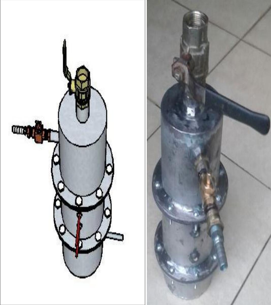
Figura N° 2 Planos de cámara de alimentación de residuos y medidas en pulgadas, reactor energético de plasma.
