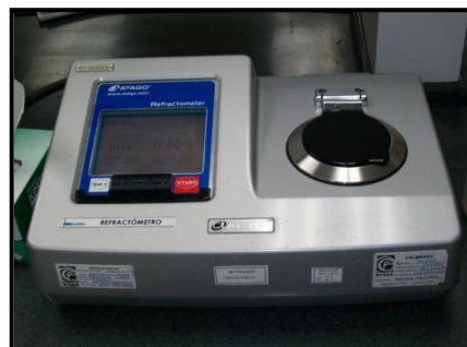
Refractómetro para determinación de brix en jugos y mieles
