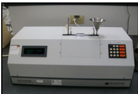
Polarímetro para análisis de pol en jugos y mieles
