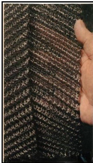
Figura 4.3: Separador de malla de alambre (Batule, 2008)
