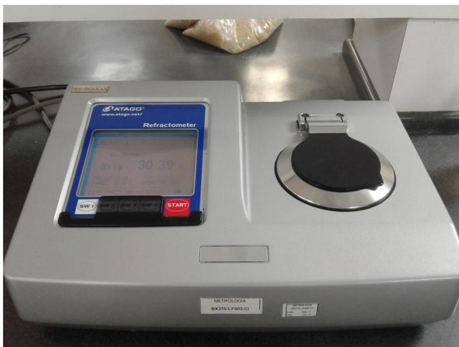
Figura 3.11. Refractómetro ATAGO Modelo: RX-5000X para medición de grados Brix
