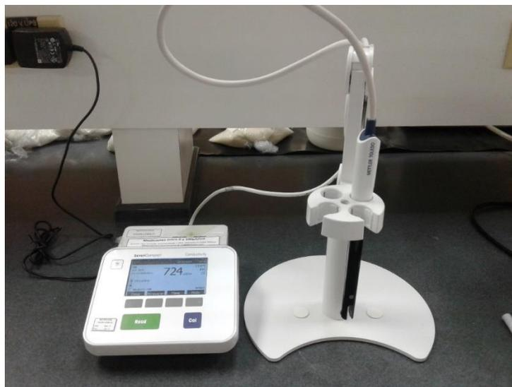
Figura 3.12. Equipo de conductimetría Mettler Toledo Modelo: Seven Compact
