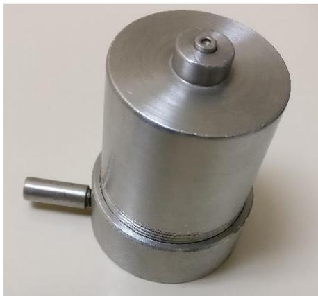
Figura 3.7. Filtro de Pistón Utilizado para separar licor madre de masa cocida.
