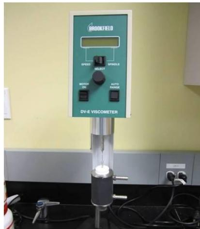
Figura 3.9 Viscosímetro Brookfield Modelo RVDV-E utilizado para caracterizar muestras de melaza
