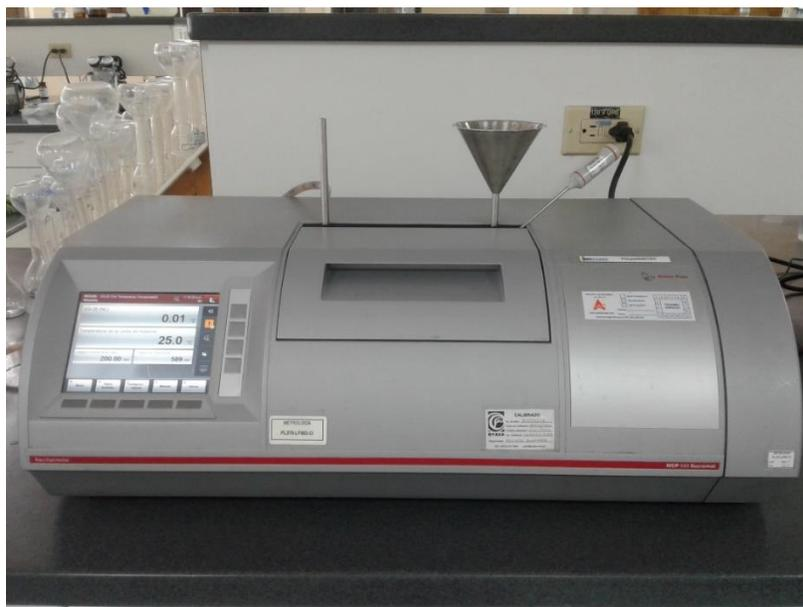
Figura 3.10. Polarímetro Especial de sacarosa (Sacarímetro Anton Paar Modelo: MCP 500 SUCROMAT)
