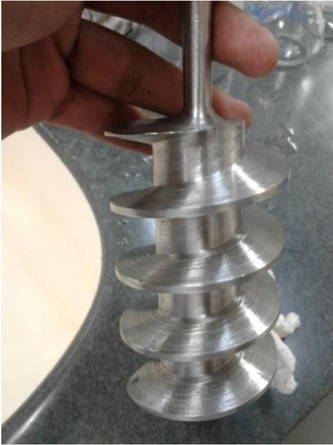
Figura 3.5. Agitador tipo tornillo sin fin.
