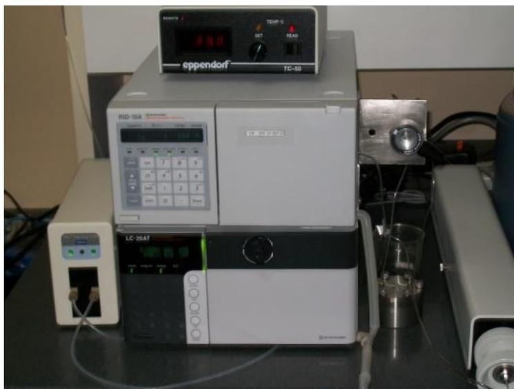
Figura 3.13. Sistema de Cromatografía líquida de alta eficiencia.
