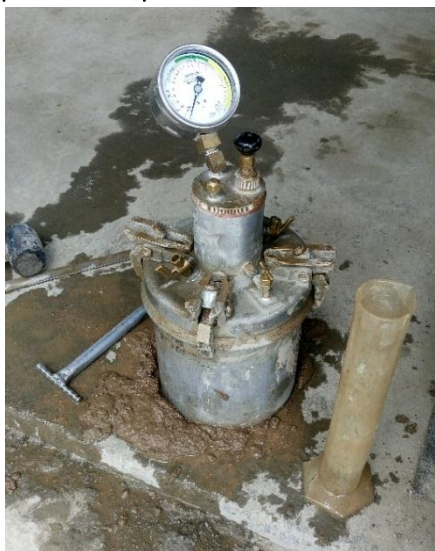
Figura 2.2 Equipo utilizado para determinar contenido de aire de la mezcla
