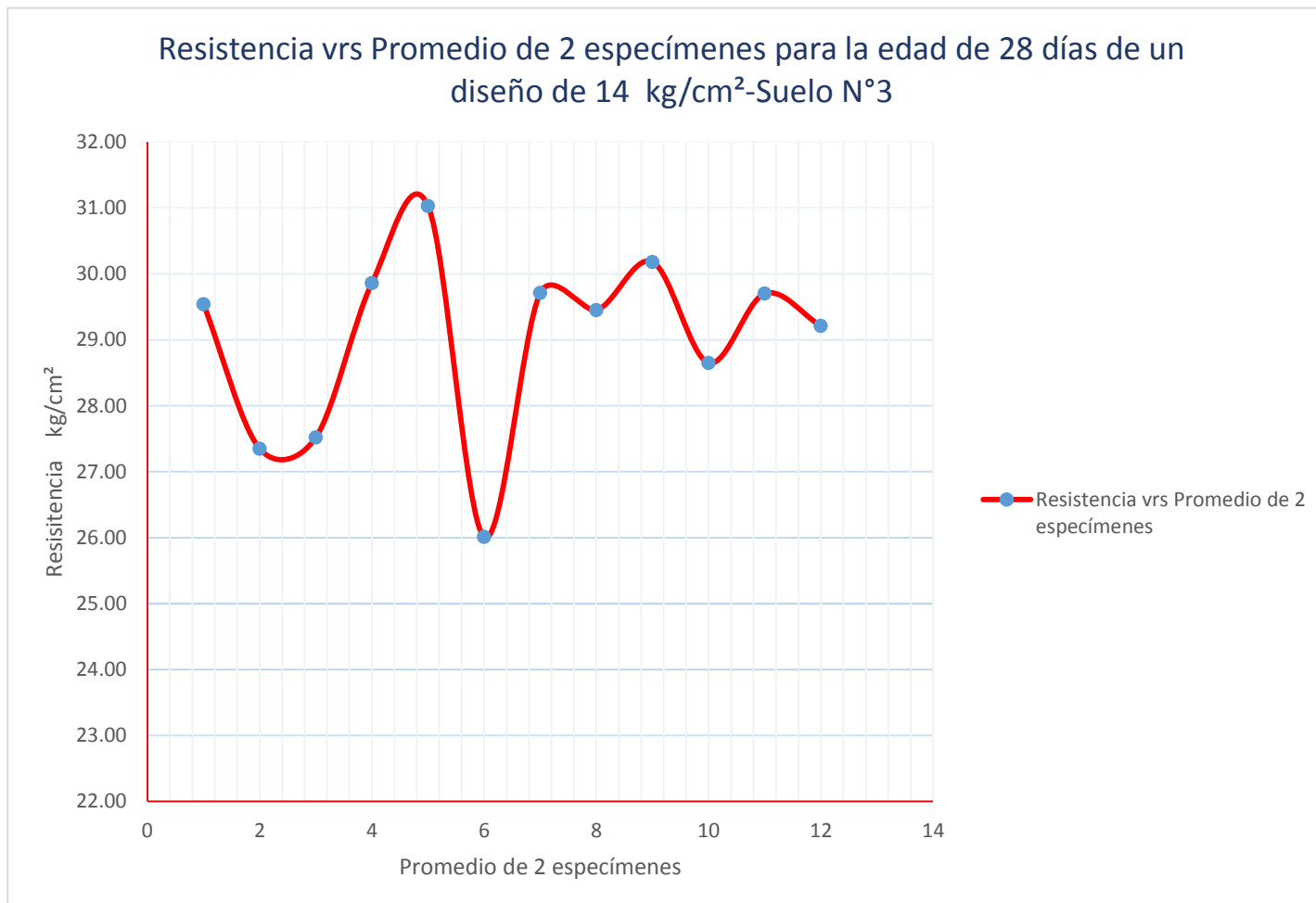
Figura 5.71 Resistencia vrs Promedio de 2 especímenes para la edad de 28 días de un diseño de 14 kg/cm 2 -Suelo N°3
