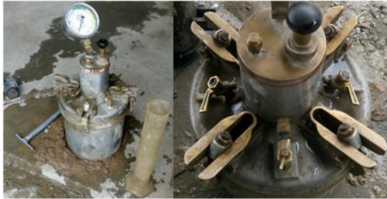
Figura 4.5 Colocación del Manómetro y cierre de las válvulas de purga.
