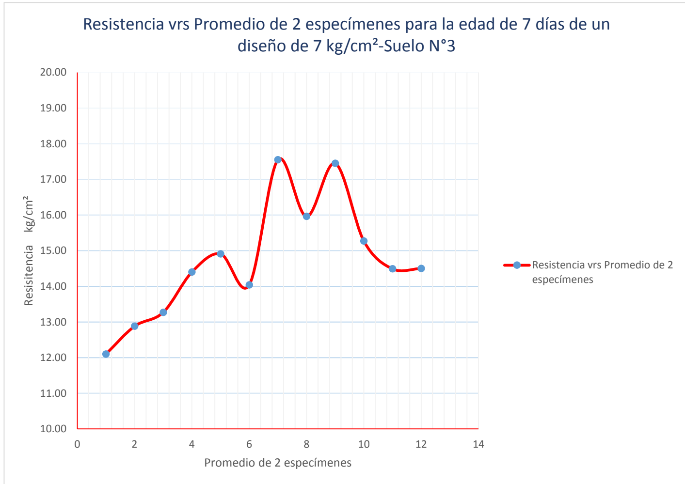
Figura 5.57 Resistencia vs Promedio de 2 especímenes para la edad de 7 días de un diseño de 7 kg/cm 2 -Suelo N°3
