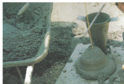
Figura 9. Medida de la consistencia de un mortero ligero con cono de Abrams
