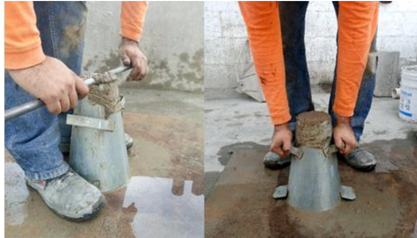
Figura 4.2 Enrasado y Levantamiento del cono de Abrams.
