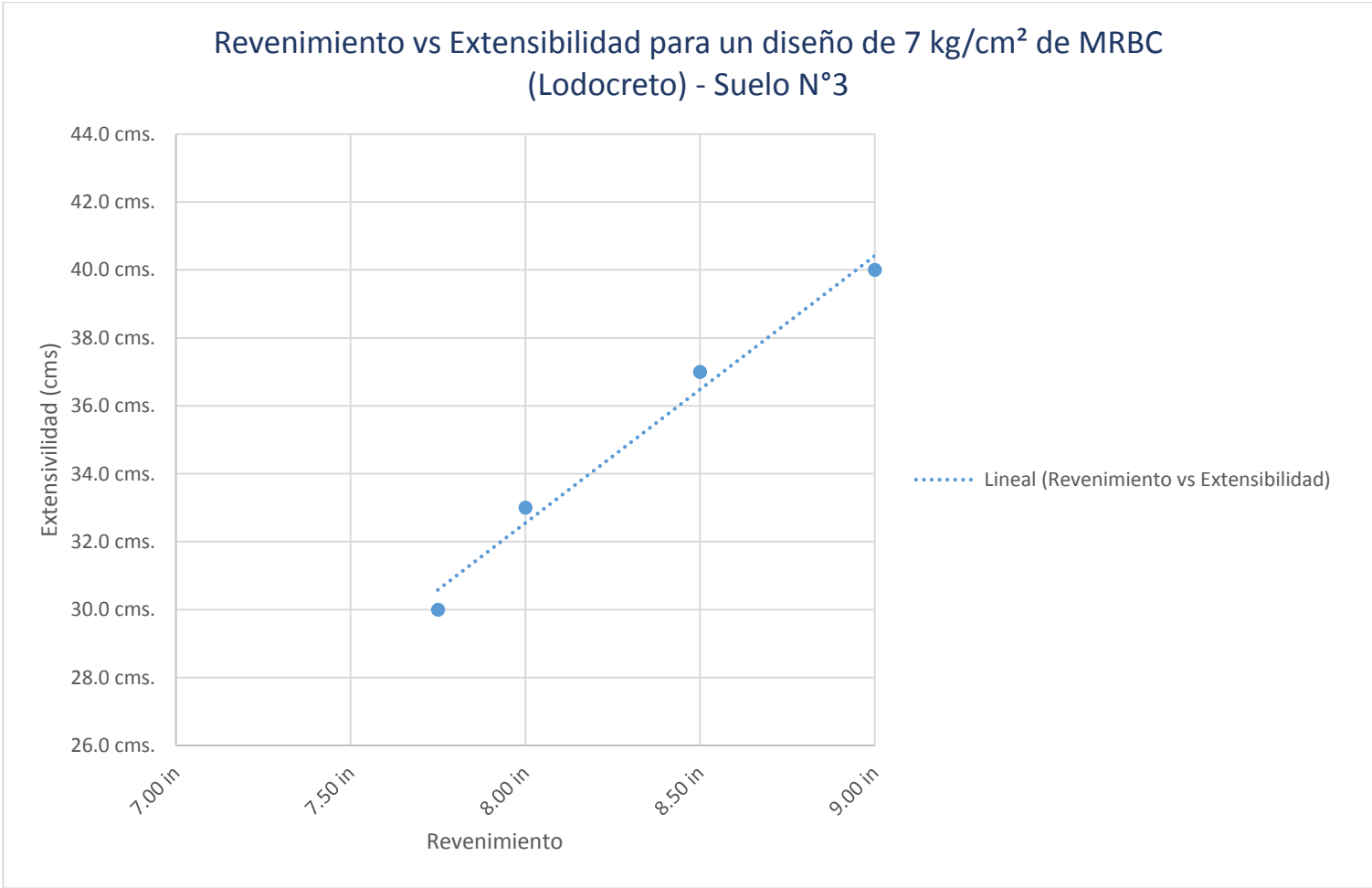
Figura 5.56 Correlación entre revenimiento y extensibilidad para un diseño de 7 kg/cm 2 de MRBC (Lodocreto) del Suelo N°3
