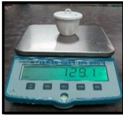
Figura 3.11 Determinando masa de los recipientes utilizados en el ensayo
