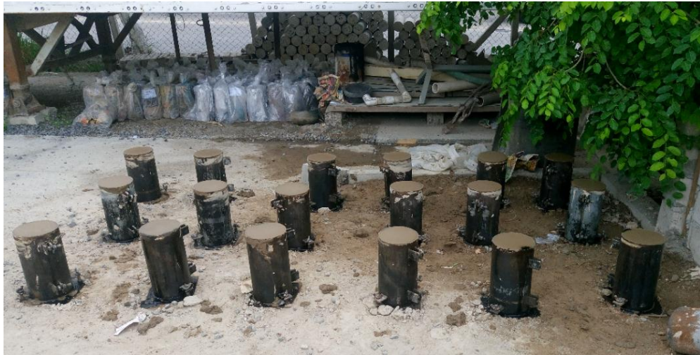
Figura 4.14 Cilindros de MRBC
