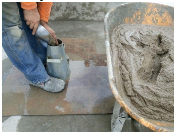
Figura 4.1 Llenado del cono Abrams
