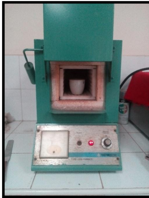
Figura 3.12 Muestra de suelo colocada en el horno mufla
