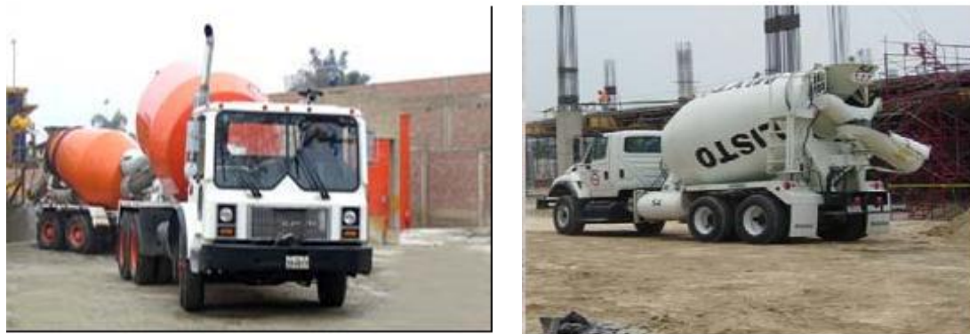
Figura 2.13 Tipos de camión mezclador para transporte de concreto y MRBC 49
