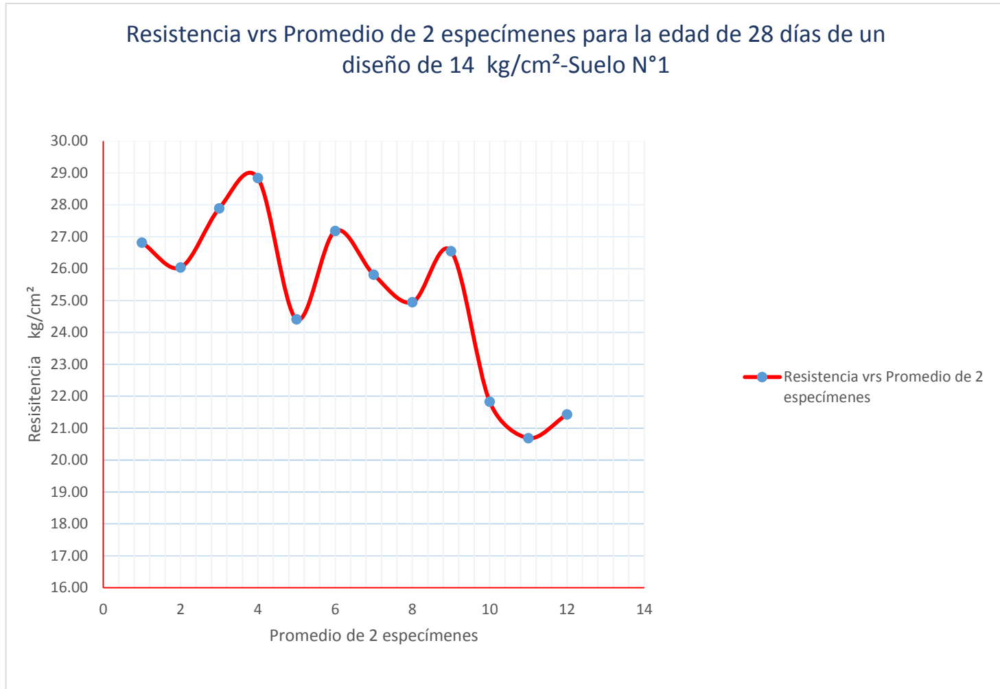
Figura 5.23 Resistencia vrs Promedio de 2 especímenes para la edad de 28 días de un diseño de 14 kg/cm 2 -Suelo N°1
