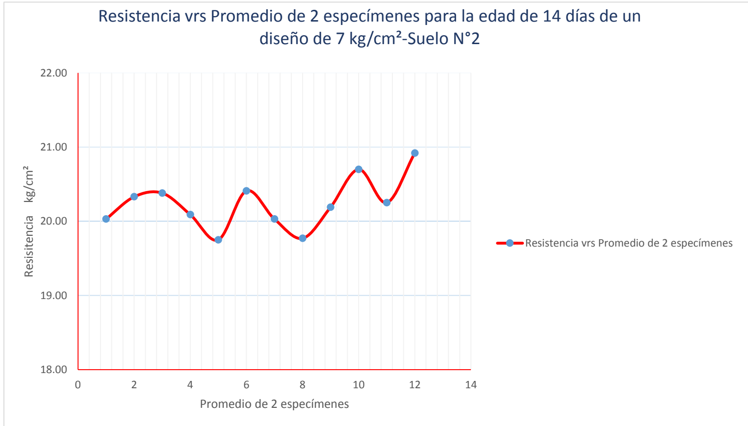
Figura 5.34 Resistencia vrs Promedio de 2 especímenes para la edad de 14 días de un diseño de 7 kg/cm 2 -Suelo N°2
