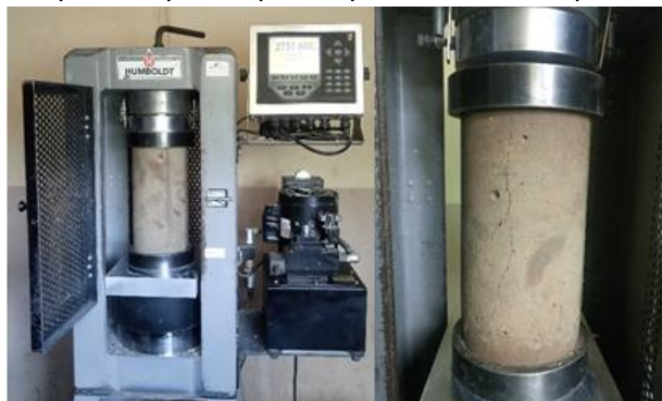
Figura 4.18 Máquina empleada para ruptura de cilindros probados a compresión.
