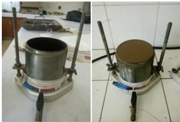
Figura 4.8 Llenado del Permeámetro.
