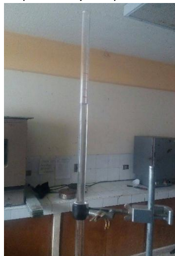
Figura 4.10 Bureta para ensayo de permeabilidad (Carga variable).
