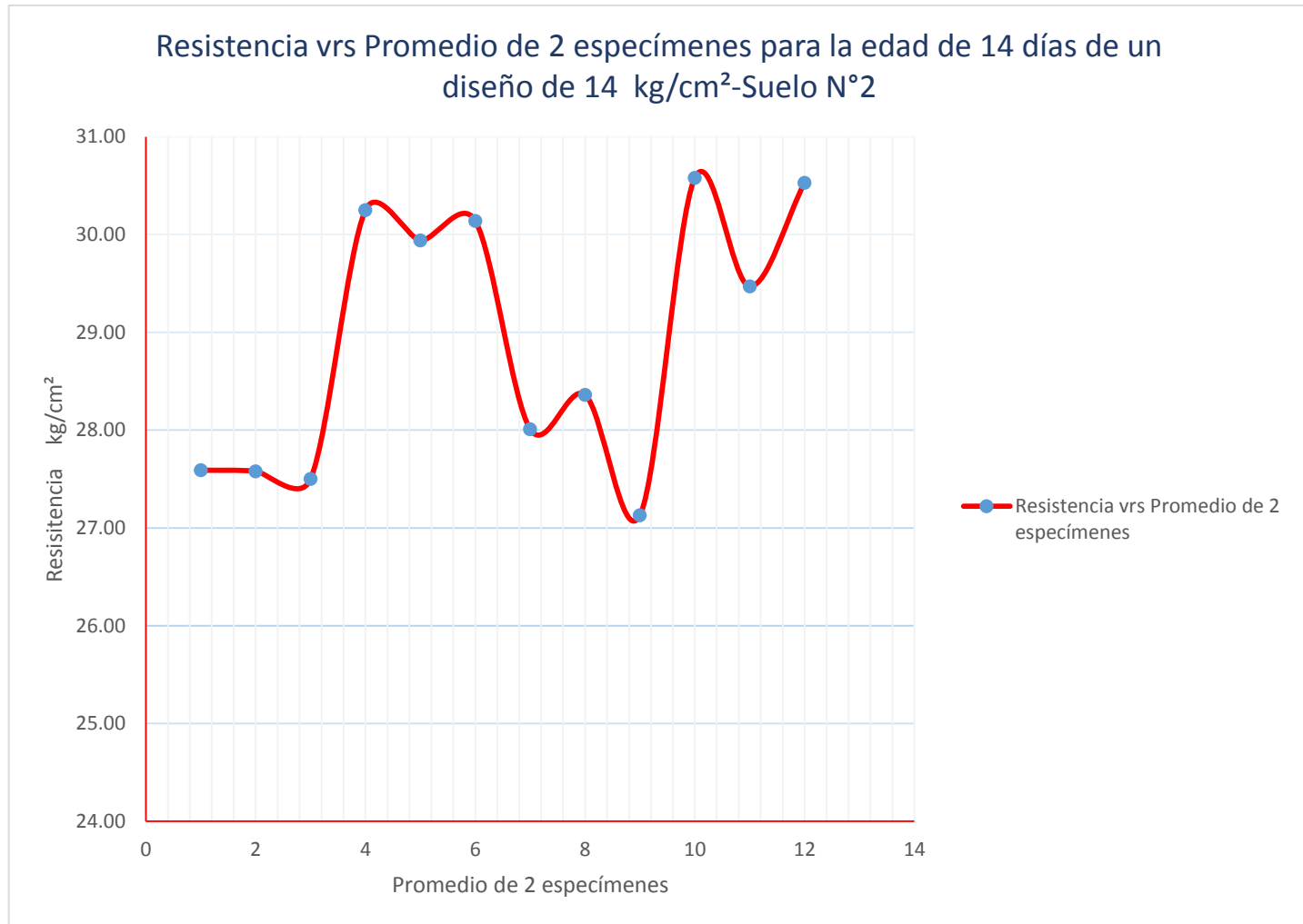
Figura 5.46 Resistencia vs Promedio de 2 especímenes para la edad de 14 días de un diseño de 14 kg/cm 2 -Suelo N°2
