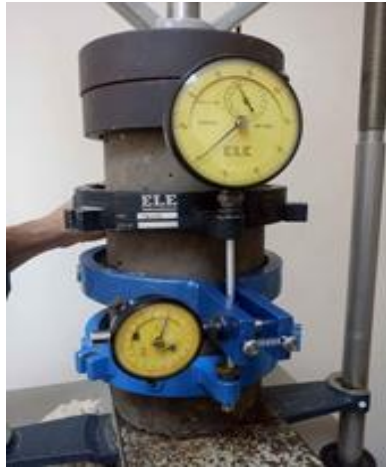
Figura 5.80 Colocación de los anillos y de los deformímetros
