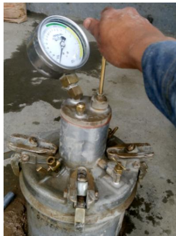
Figura 4.6 Bombeo de aire en la cámara.
