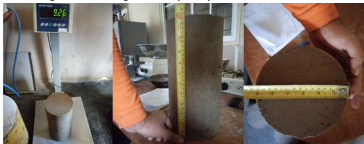
Figura 4.16 Registro del peso y dimensiones del cilindro.
