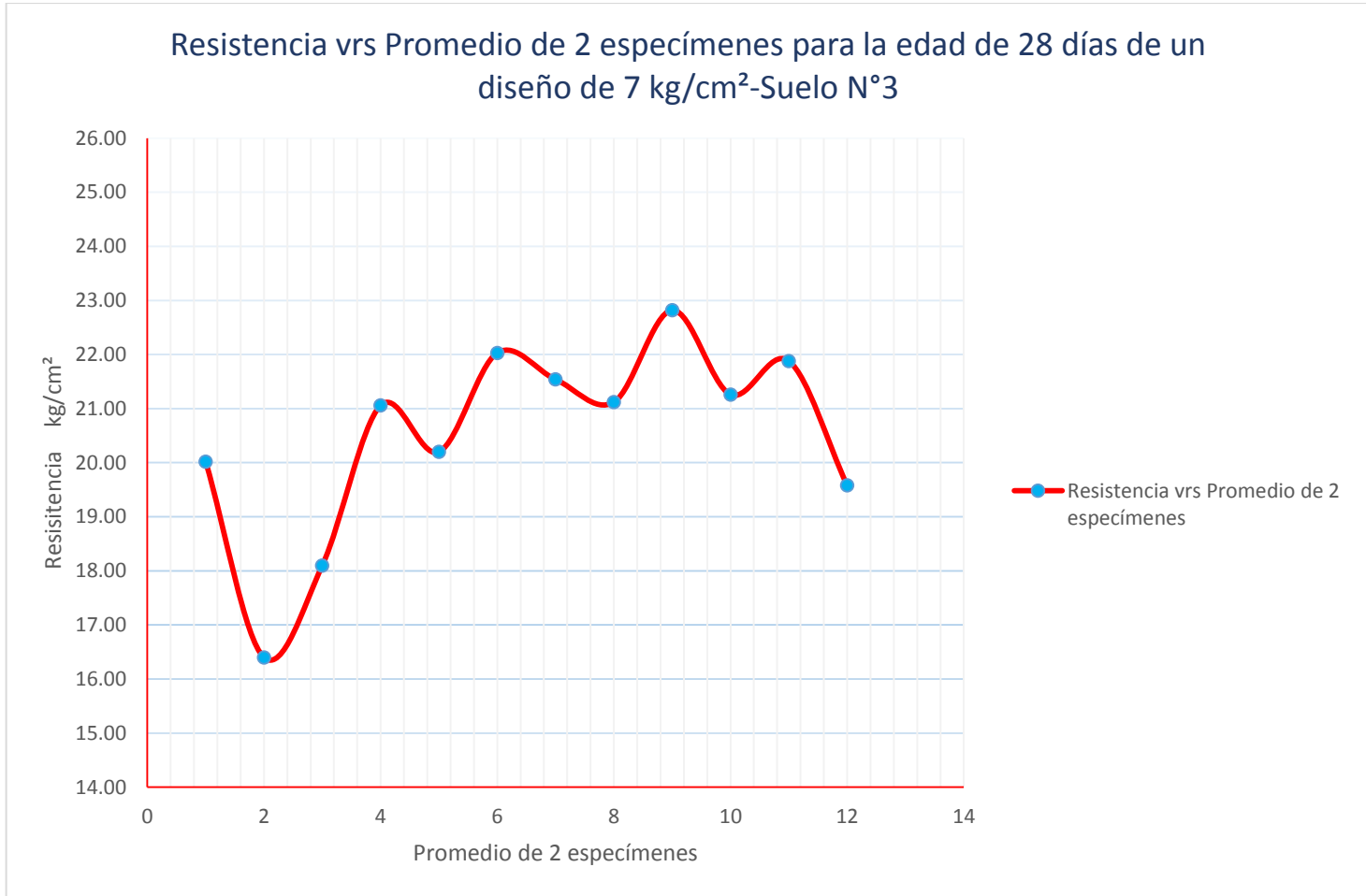
Figura 5.59 Resistencia vrs Promedio de 2 especímenes para la edad de 28 días de un diseño de 7 kg/cm 2 -Suelo N°3
