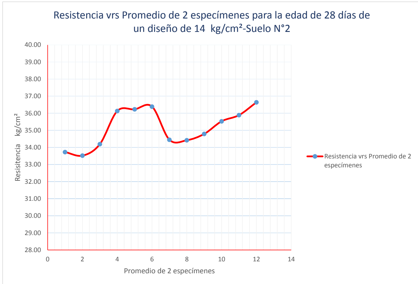
Figura 5.47 Resistencia vrs Promedio de 2 especímenes para la edad de 28 días de un diseño de 14 kg/cm 2 -Suelo N°2
