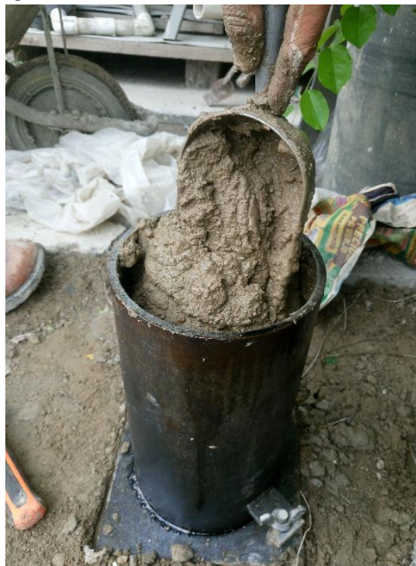
Figura 4.12 Proceso de llenado de los cilindros.
