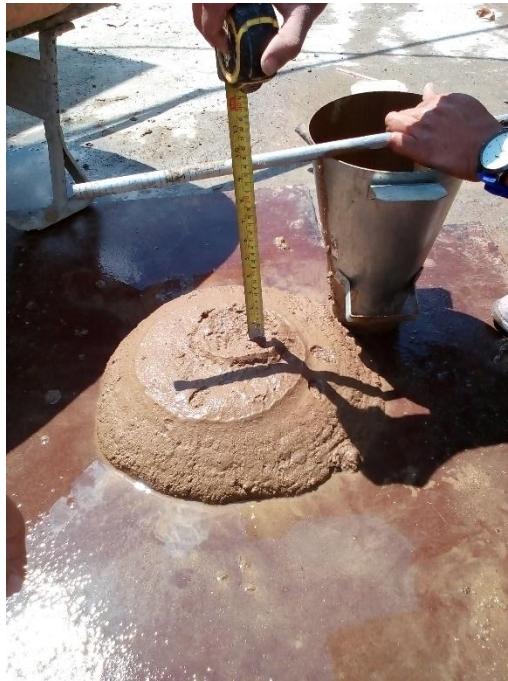
Figura 2.1 Equipo utilizado para determinar el revenimiento de la mezcla
