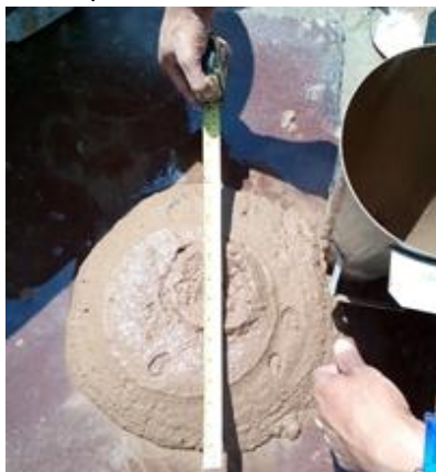
Figura 2.3 Método para determinar la extensibilidad de la mezcla
