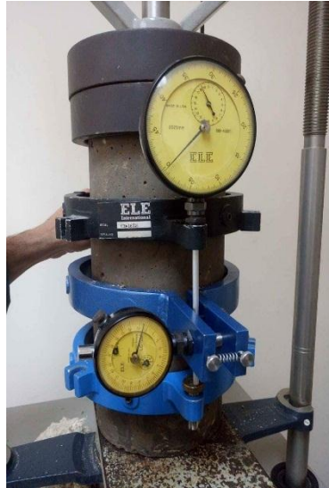
Figura 4.20 Colocación de los anillos y de los deformímetros.
