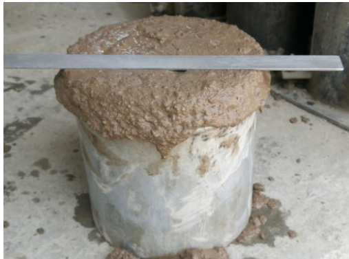
Figura 4.4 Enrasado del molde para contenido de aire.
