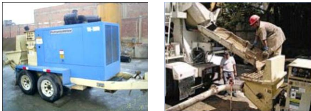
Figura 2.14 Modelo de bombas utilizadas para distribuir lodocreto
