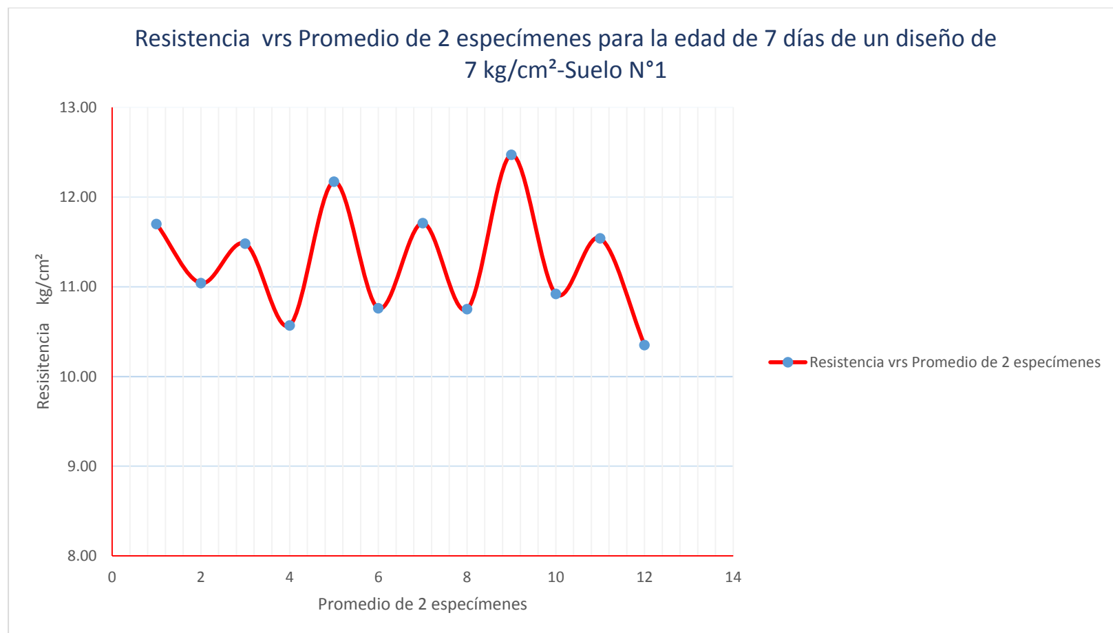
Figura 5.9 Resistencia versus Promedio de 2 especímenes para la edad de 7 días de un diseño de 7 kg/cm 2 -Suelo N°1
