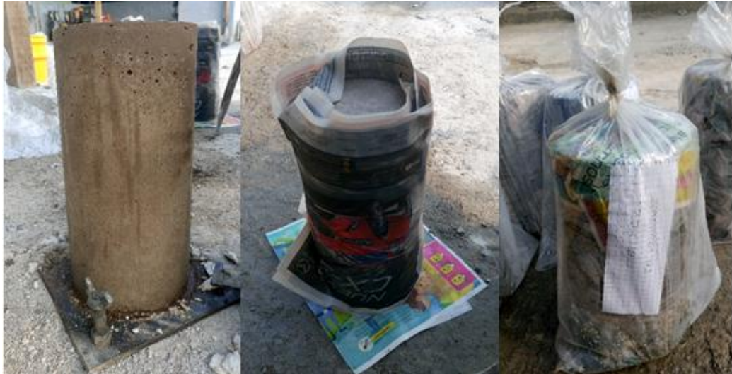
Figura 4.15 Curado de los cilindros de MRBC
