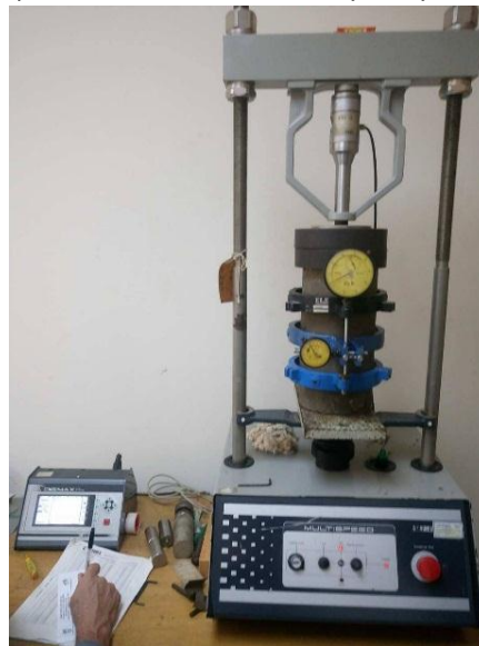
Figura 4.21 Espécimen colocado en máquina para realizar el ensayo.
