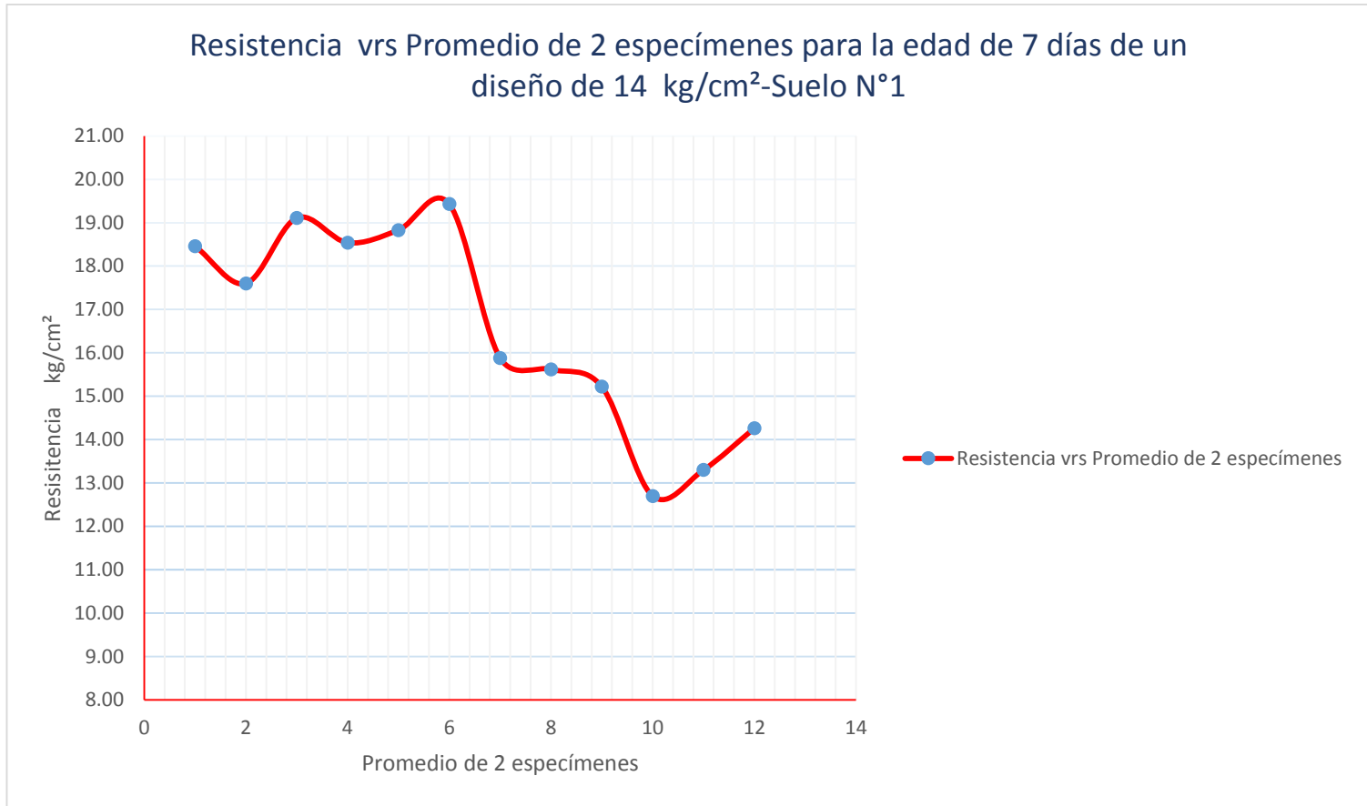
Figura 5.21 Resistencia vrs Promedio de 2 especímenes para la edad de 7 días de un diseño de 14 kg/cm 2 -Suelo N°1
