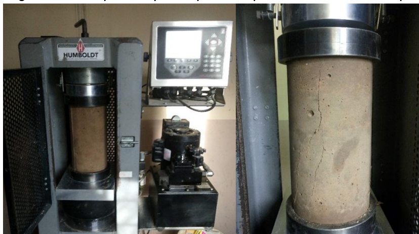
Figura 2.4 Maquina empleada para la ruptura de cilindros a compresión
