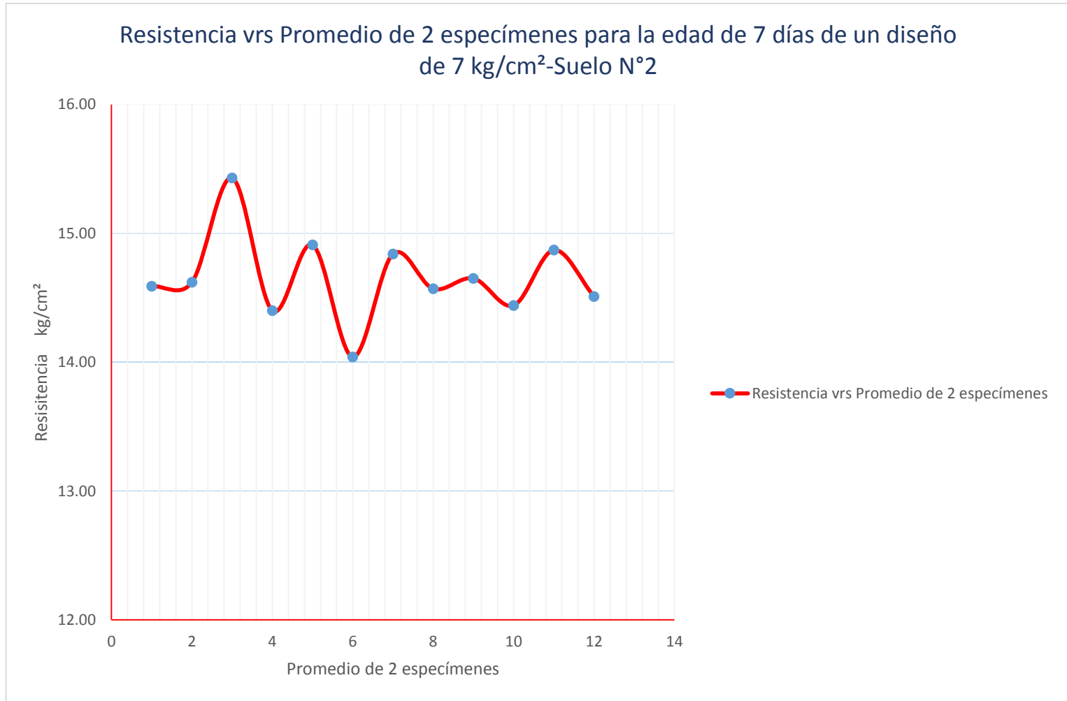
Figura 5.33 Resistencia vrs Promedio de 2 especímenes para la edad de 7 días de un diseño de 7 kg/cm 2 -Suelo N°2
