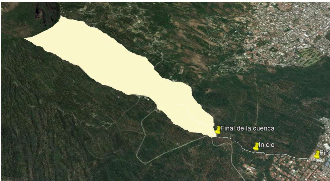
Figura 3.1.4 Cuenca de la Quebrada Buenos Aires y tramo obtenido en el levantamiento topográfico.
