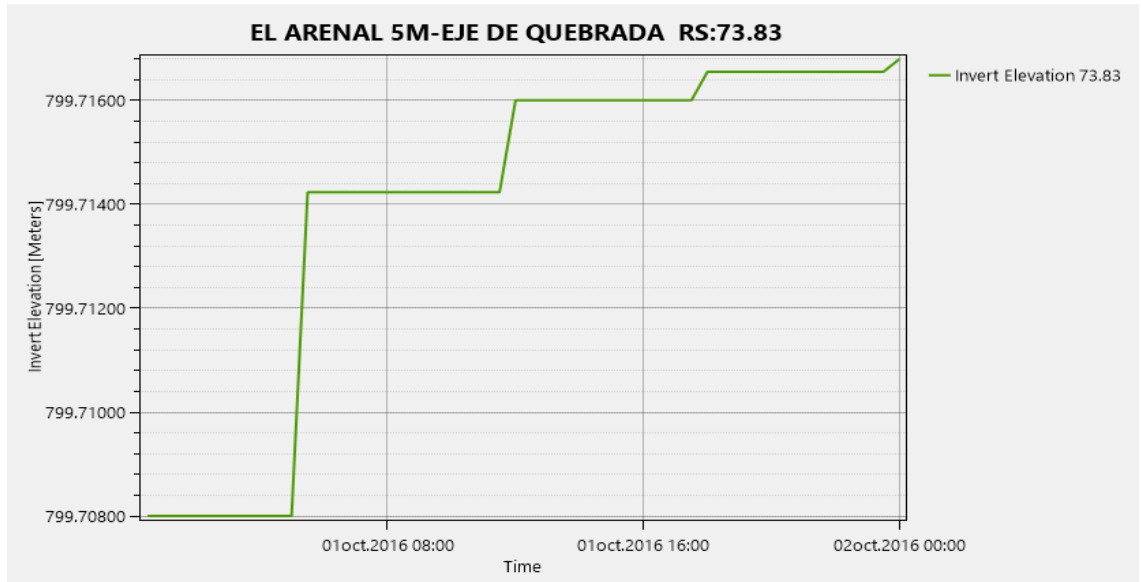
Figura 5.3.2 Gráfica que representa el cambio de elevación que sufre la sección 2 de la quebrada El Arenal de Mejicanos.
