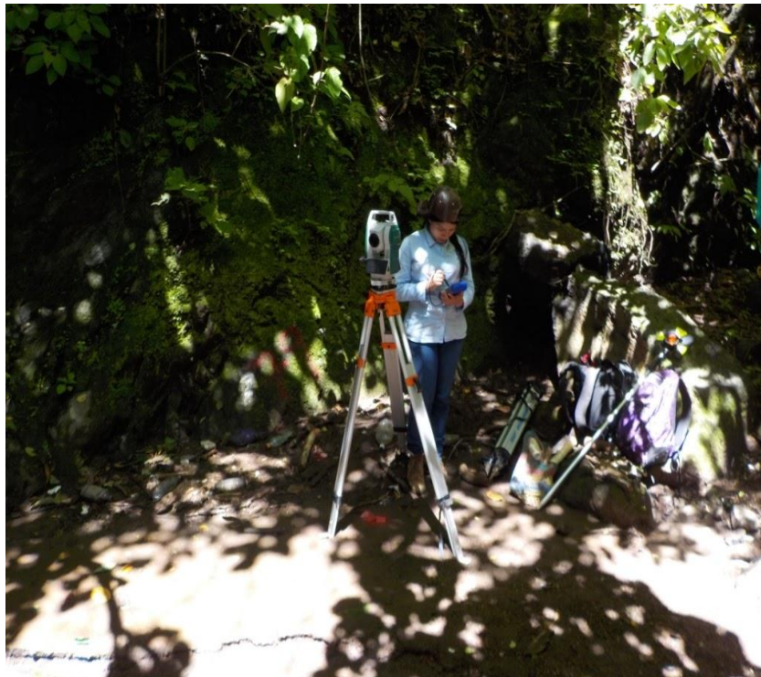
Figura 3.1.6 Toma de datos en Quebrada Buenos Aires con estación total en sincronía con el colector Carlson.
