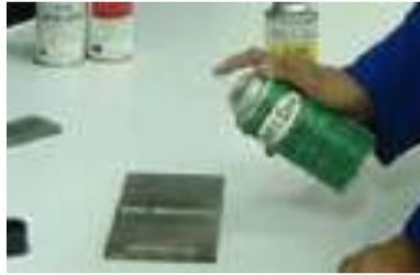
*Figura 3. Muestra el momento en que se aplica Liquido Penetrante*
