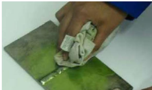
*Figura 4. Se muestra como se remueve el exceso de Liquido Penetrante.*
