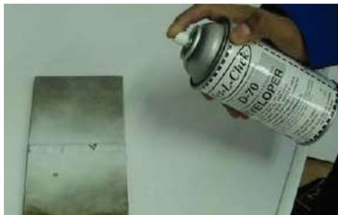
*Figura 6. Se puede observar el momento en que se aplica el Revelador.*
