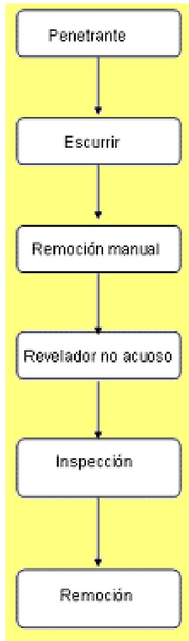
*Fig.12. Diagrama que nos muestra los pasos a seguir para la realización de la prueba de líquidos penetrantes en su Proceso C: Penetrante Fluorescente Removido Con Solvente.*
