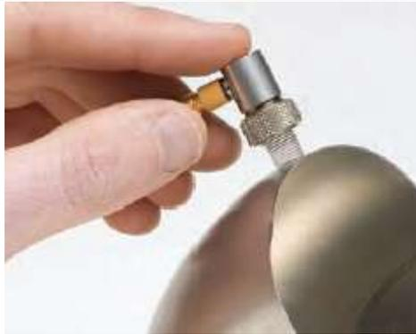
*Figura 38. Aquí se observa un palpador de línea retrasada.*
