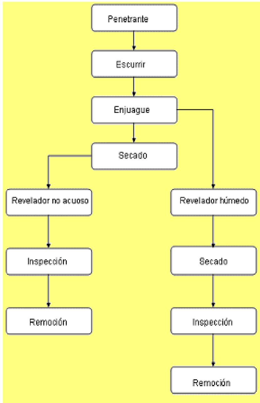
Fig.13. Diagrama que nos muestra los pasos a seguir para la realización de la prueba de líquidos penetrantes en su Proceso A: Penetrante Visible Lavable con Agua
