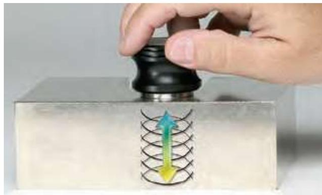
Figura 34. Representación de cómo se propagan las ondas ultrasónicas en la pieza analizada..
