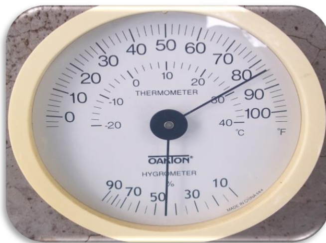
Figura A-2. Equipo e instrumento que mide temperatura en grados Celsius y humedad relativa en porcentaje en 24 horas del día UES-CC. AA. Tesis 2017.
