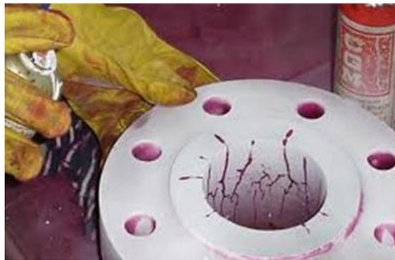
*Figura 4.7.6: Prueba de líquidos penetrantes.*
