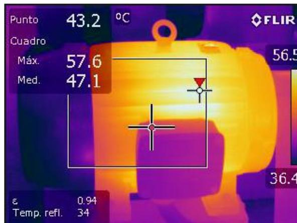
*Figura 4.7.3: Análisis termográfico de un motor eléctrico.*
