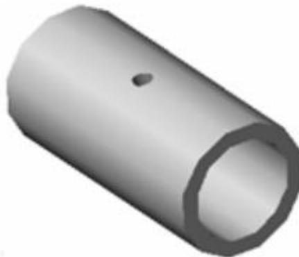
*Figura 1.1.1-4: Imagen Cojinete tipo deslizamiento. [2]*
