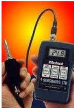
*Figura 4.7.1. Analizador portátil de vibraciones*
