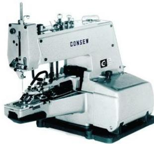
**Figura 9: Máquina Botonadora**
