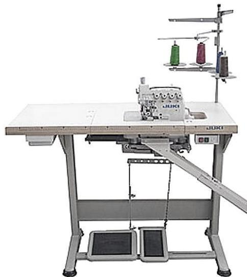
**Figura 7: Máquina Overlock**
