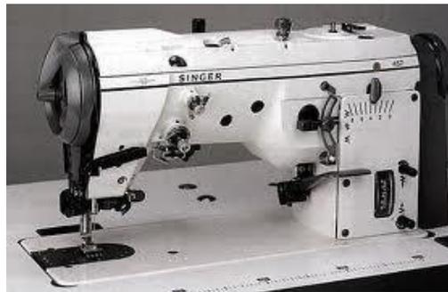
**Figura 15: Máquina de coser Zigzag 3 pasos**
