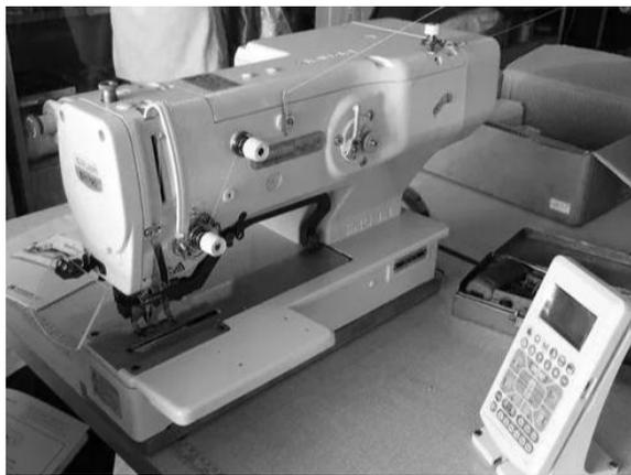
**Figura 18: Máquina de ojal con panel numérico.**
