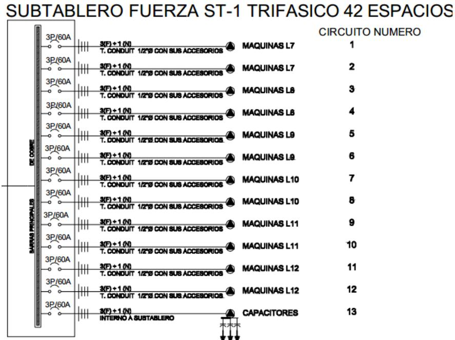
Figura 39: Tablero alimentador de línea 5 a 8.
