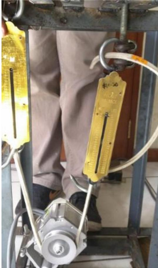
**Figura H10:** Medición de torque a motor de inducción y Servomotor.
