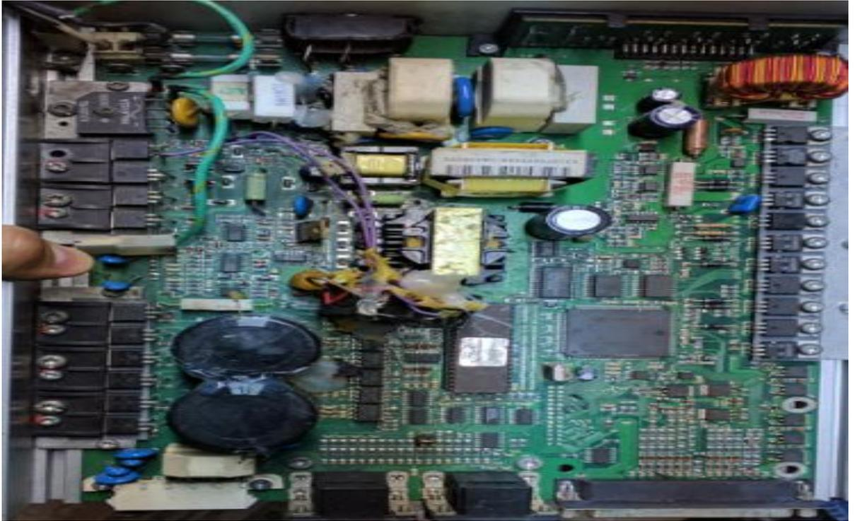
**Figura H8:** Circuito electrónico de control de antigua Máquina Overlock.
