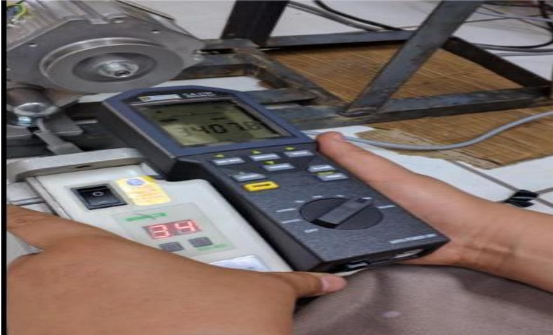
**Figura H11:** Medición de velocidad angular a Servomotor.
