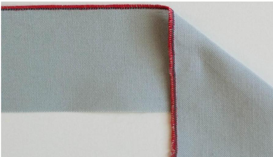
Figura 22: Costura de 2 hilos con Máquina Overlock.
