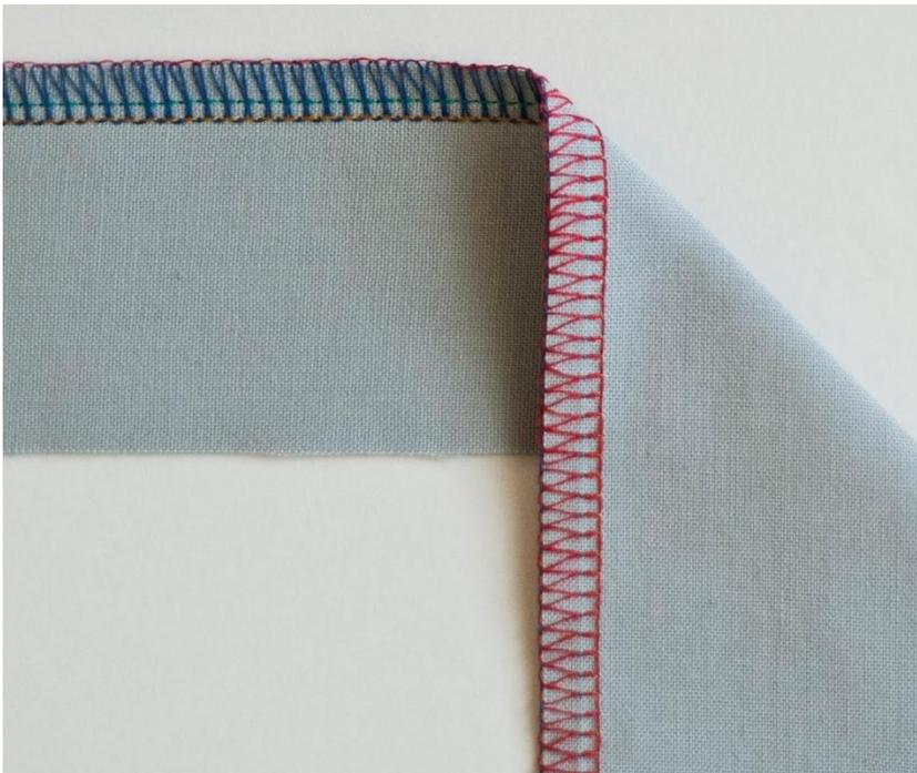
**Figura 24: Costura de Máquina Overlock de 4 hilos.**
