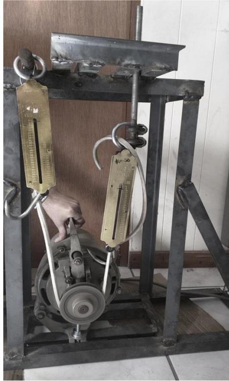
**Figura 33: Medición de torque del motor de embrague mediante principios del freno de Prony.**
