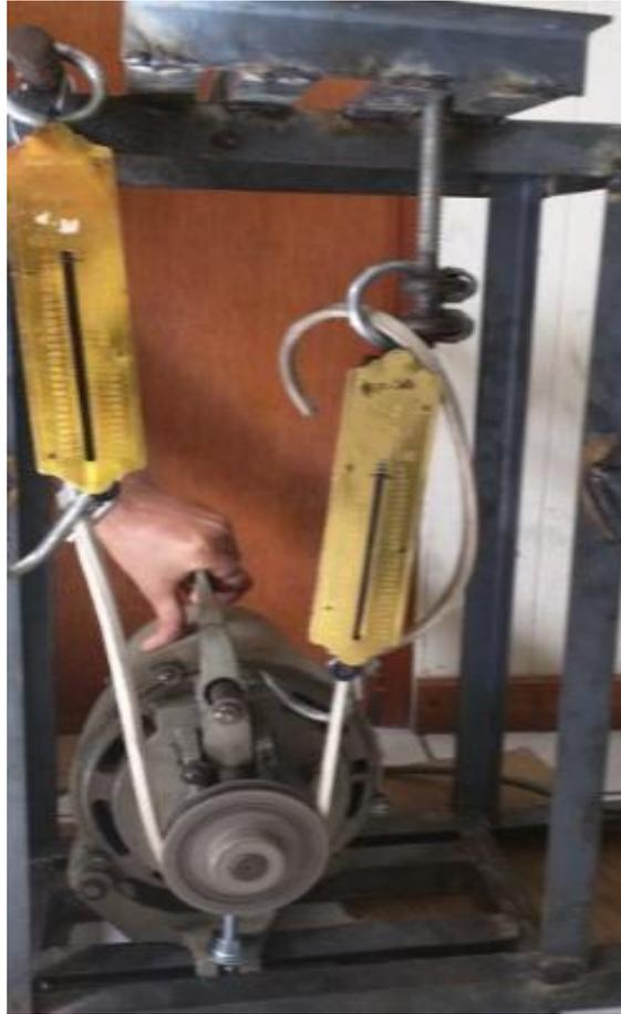
**Figura H9:** Medición de torque a motor de inducción.
