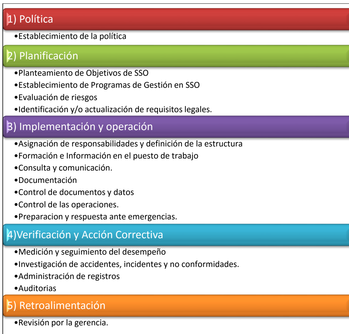
Figura 4. Etapas del Modelo del Sistema de Gestión. Elaboración propia basada en la Norma OHSAS 18000:2007
