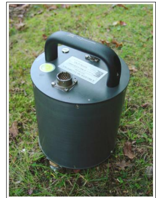
Fig. 26 Sismómetro CMG-6TD (Güralp Systems, 2008).
