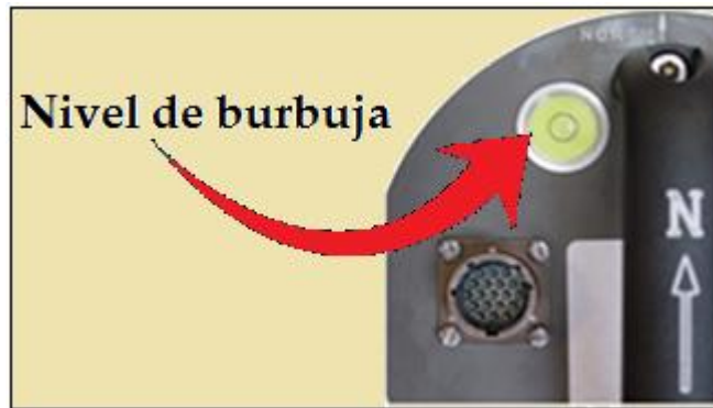
Fig. 44 Panel superior del sismómetro 6TD, nivel de burbuja centrado.
