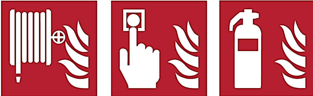
Señalizaciones de equipo contra incendios, de Izq. A Der: Manguera contra incendios, Activador de alarma de incendios, Extintor contra incendios.
