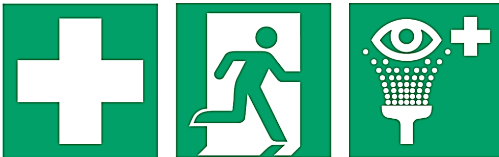
Señalizaciones de salvamento, de Izq. A Der: Primeros auxilios, Salida de emergencia a mano derecha, Estación de lavado de ojos.
