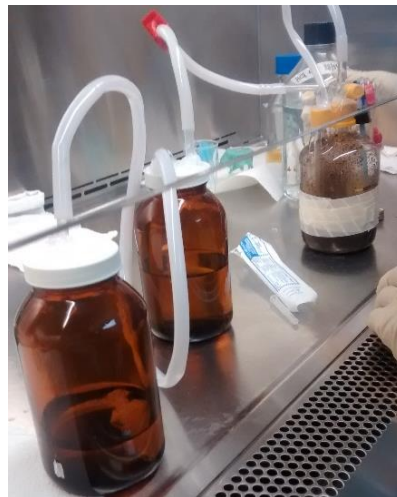
Figura 2.5: Cámara de anaerobiosis, trampa de agua y biorreactor de fermentación láctica.
