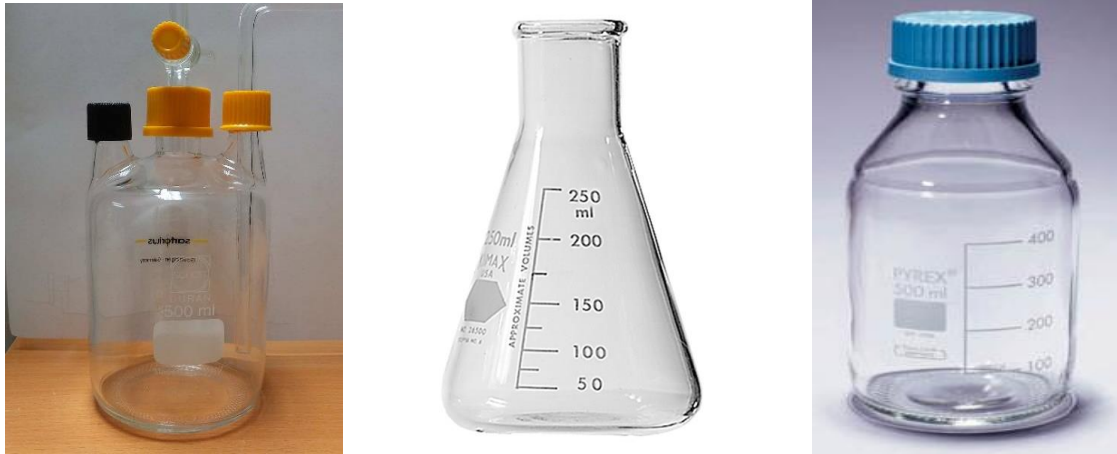
Figura 2.4: Biorreactores de borosilicato utilizados en la investigación.
