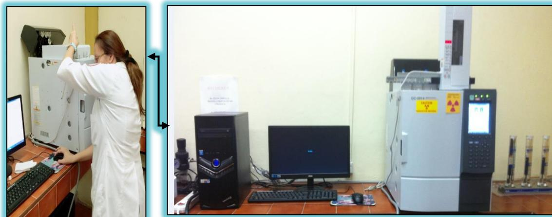
**Figura 45.** Proceso de inyección manual en el cromatografo de gases y Cromatografo de gases marca Shimadzu modelo GC-2014
