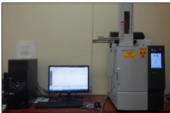
**Figura 26** Cromatografo de gases marca Shimadzu modelo GC-2014
