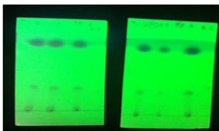
**Figura 21.** Placas ALUGRAM sílica gel 60 al visualizar bajo la lámpara Ultravioleta
