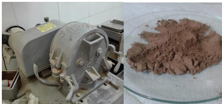
Figura 2.4 Pulverizadora de discos y material molido.
