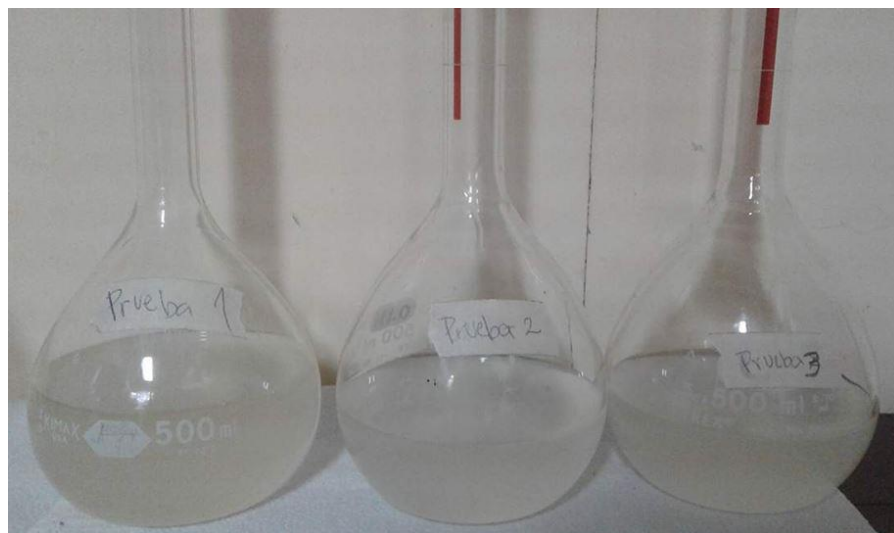
Pruebas de concentración de hidróxido de sodio y silicato de sodio para la solución alcalina
