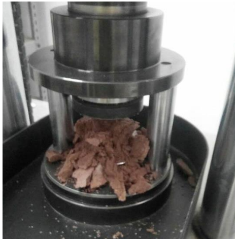
Figura 4.1 Resultado de Ensayo de resistencia a la compresión
