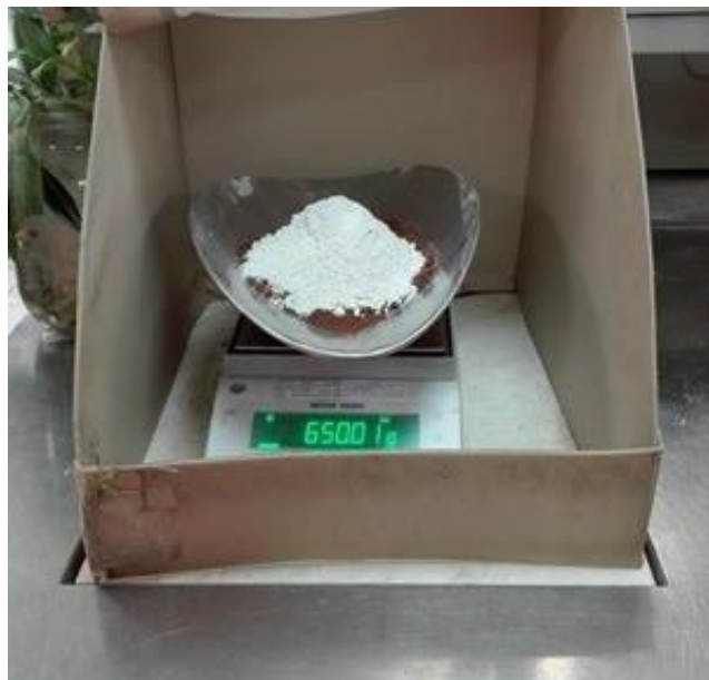
Pesado de cal y material activado
