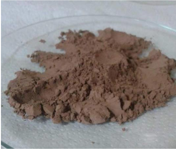
Material activado triturado en triturado de discos
