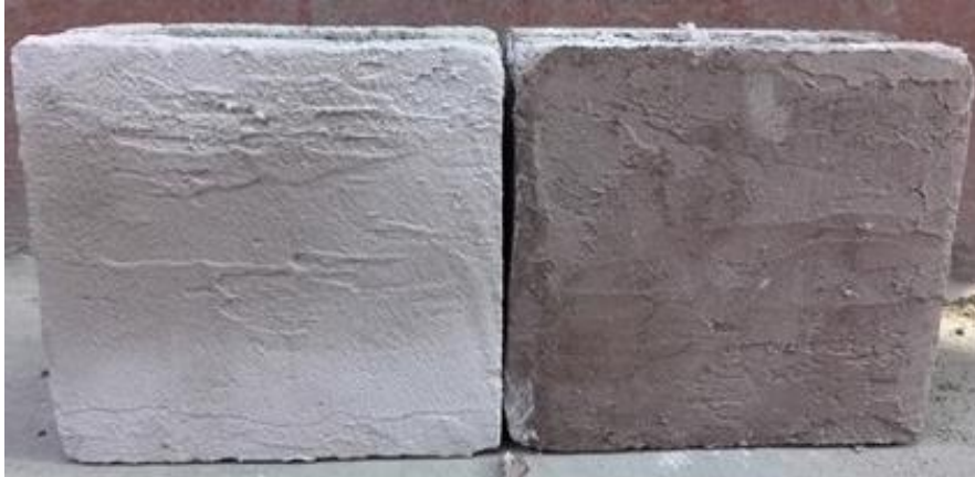
Figura 5.1 Fotografía de pruebas obtenidas en el repello de bloques de ladrillo de hormigón
