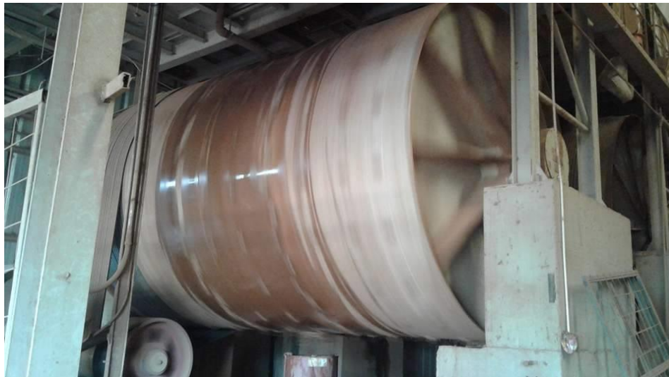
Figura 0.3 Fotografía de trituración de arcilla en molino de bolas por vía semi-húmeda.
