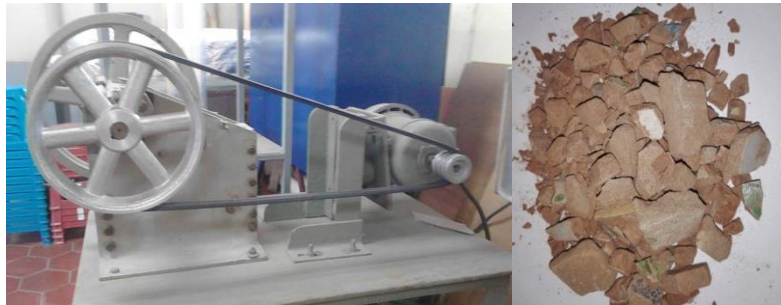
Figura 2.3 Trituradora de mandíbula y material triturado.
