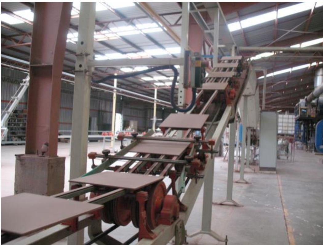
Figura 0.4 Fotografía del transporte de piezas de conformado hacia horno, luego de moldeo
