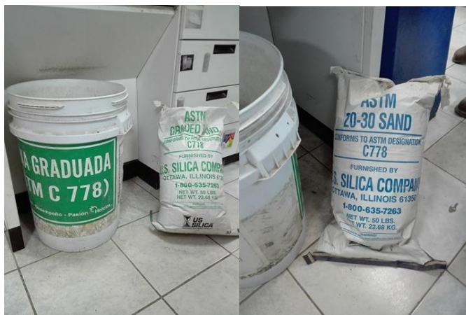
Figura 3.7 Arena estandarizada utilizada en pruebas.
