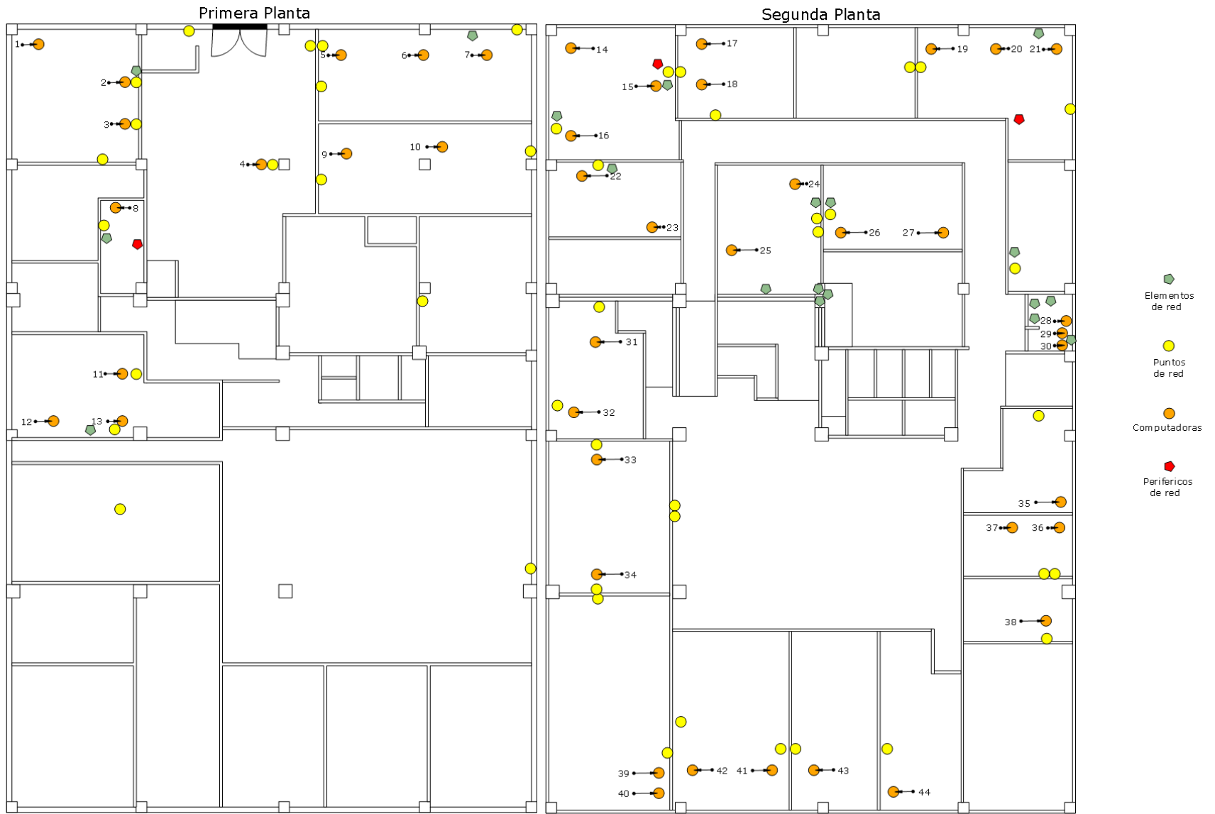
Figura 89. Detalle de la Unidad Central, todos los componentes de la red.
