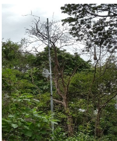
Figura 36. Antena ubicada en la cancha del Parque Ecoturístico Tehuacán que conecta con la antena de Alcaldía.
