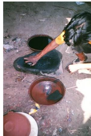
3- El plomo se recoge con una esponja y se lava en una sartena con agua, se espera ha que asiente lo pesado y después se “florear” o sea verter en otro depósito lo que flota, utilizando la mano como colador, para que no pase la granza o plomo no molido.
