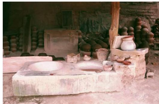
La preparación consiste en colocar una tabla atravesando un lado de las pilas (al frente) que es donde se colocarán las piezas después de sus respectivos baños con la mezcla del vidriado.
