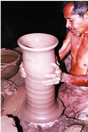
6° - Se vuelve a estirar el barro hacia arriba rompiendo el ánchete con los dedos pulgares; se ejerce presión hacia fuera para abrirlo más; posterior a esta acción, se señaliza para determinar el tamaño de la pieza.
