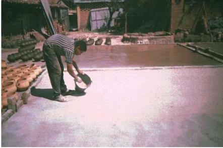
4. *Batir la moja*, que esta en la pila de colar esto se hace continuamente hasta dejar bien mezclado y no quede nada asentado. A esta acción se le llama espesado de la mezcla. El mezclado es realizado con un azadón de mango largo.
