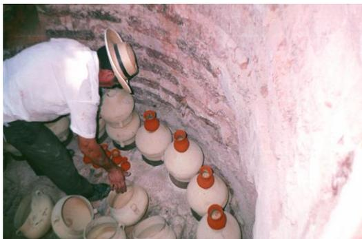
*La colocación de ollas enteras, astillas y quemadas en el contorno de arriba del horno sirve para detener los “carros” entre la pared del horno; esto se hace por la irregularidad del horno; ya que por el paso del tiempo y el frecuente uso se ha generado un desplome de las paredes hacia fuera. Siendo necesario cubrir el espacio entre las ollas y las paredes para que no se muevan las piezas durante la quema y también para evitar salidas de calor.*
