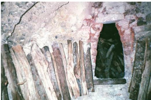
Durante ese tiempo, esta actividad es un precalentamiento del horno y de las piezas para evitar el choque de calor y por ende el rompimiento de las piezas. También genera que las piezas de la cama se endurezcan y soporten el peso de las otras que se colocaran encima para formar el copete.
