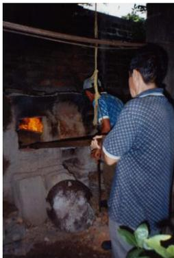
Por la forma del movimiento, lo fundido salta en forma de gotas hacia el frente. Todo lo que se retiene al contorno de lo fundido se vuelve arenilla, ha esto se le llama “oxidar el plomo”.
