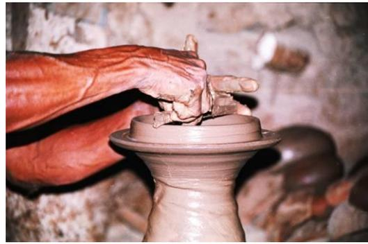
11º- Para finalizar se utiliza el torzal, herramienta para cortar la pieza ya elaborada, esta es cortada por la base con el torno siempre en giro; pero un poco más lento.
