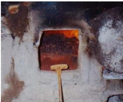
Este trabajo se hace sin descuidar el calor del horno, toda la arenilla que flota sobre lo fundido es empujada con el rodillo para el fondo del horno.
