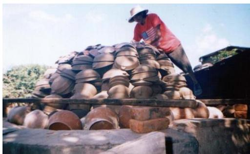
Para un mayor ordenamiento comienzan colocando las piezas por el centro, auxiliándose por unas costaneras de madera, sobre la orilla del horno, ya que el diámetro del horno es grande y no alcanzarían a colocar las piezas en el centro sin ayuda de estas.
