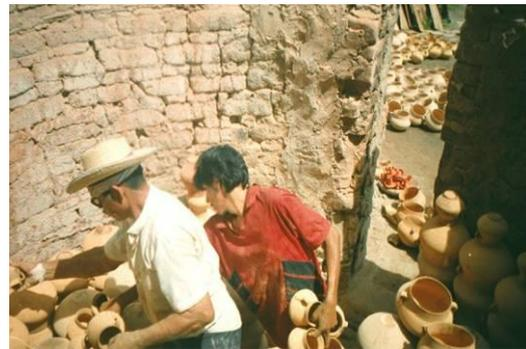
A continuación en la fotografía se aprecia la forma en que se inicia el ordenamiento de las piezas, colocando unas sartenas boca abajo (trasquil) sobre las cuales se apoyan los carros.
