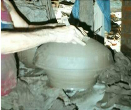
3 – Con la pieza puesta en la horma y el torno girando suave se golpea a los lados con una mano y con la otra se apoya para lograr centrarla.
