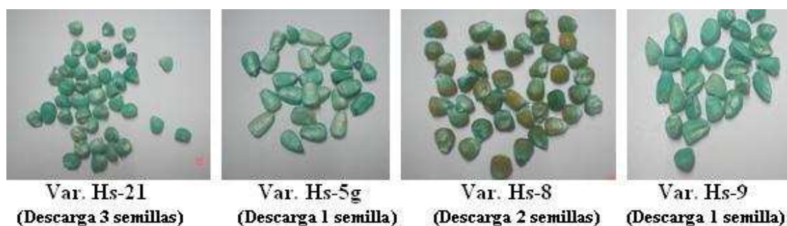
Figura 48. Resultados de descarga de grano por accionamiento en el sistema dosificador
