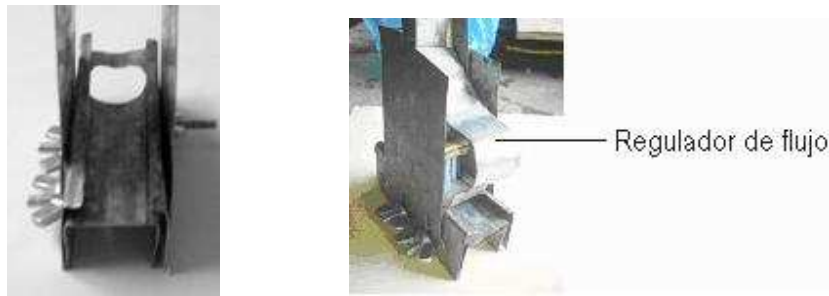
Figura 16. Segunda construcción del dosificador horizontal, regulador de flujo y limpiador.
