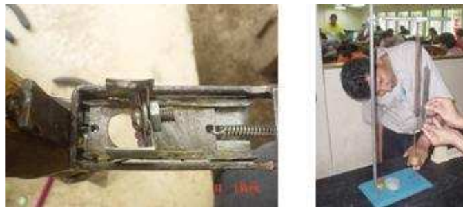
Figura 32. Prueba de evaluación de la elongación del resorte agregando pesas.
