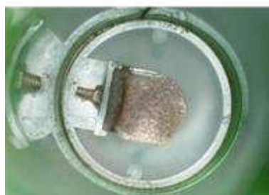
Regulador de flujo dentro de la tolva.
