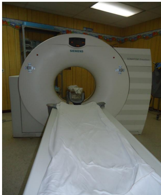
Figura N°6. Muestra dos componentes de un equipo multicorte de tomografía: La mesa y el Gantry.
