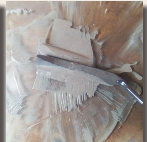
*Mezcla de ball-clay, arcilla de ladrillo y talco.
