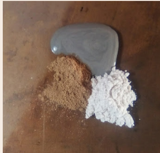
*Mezcla de ball-clay, arcilla de ladrillo y talco.
