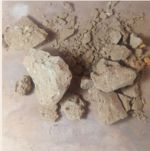
*Pulverización y tamizado de ladrillo seco para elaborar engobes
