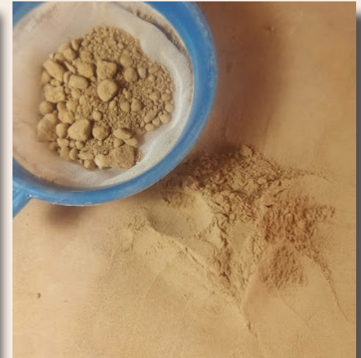
*Pulverización y tamizado de ladrillo seco para elaborar engobes
