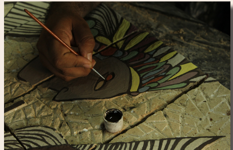
*Aplicación de engobes sobre ladrillos crudos.
