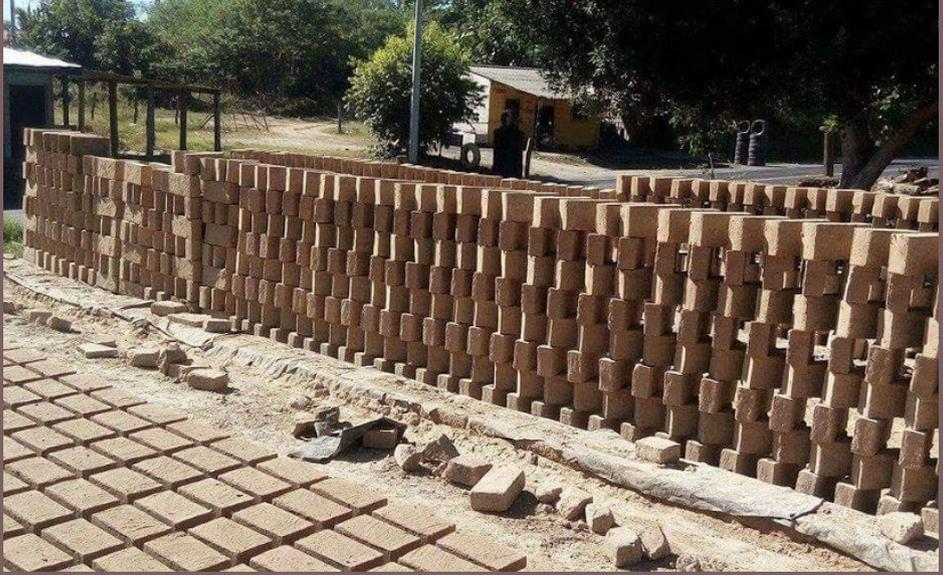
Los ladrillos de obras deben ser adquiridos en ladrilleras de producción artesanal, por lo cual debe identificarse previamente donde se comprara el producto, los precios de este oscilan entre los 0.12 a 0.20 centavos de dólar. Los ladrillos deben de estar en estado crudo, antes de secos, y con bastante humedad, deben de empaquetarse individualmente y almacenarse en un ambiente fresco y seco, se recomienda utilizarlos en un periodo no mayor de un mes.
