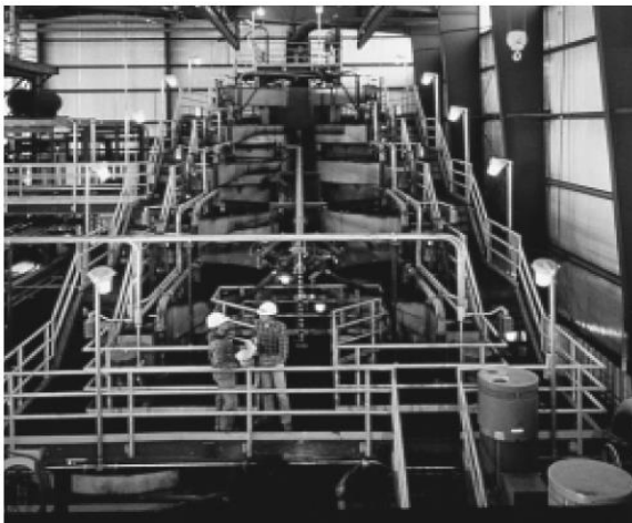
Recuperación de oro de la solución de cianuro utilizando carbón activado (carbón vegetal).
