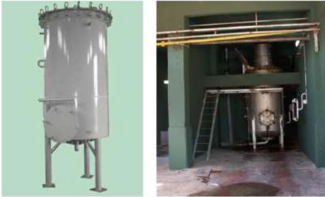
Figura N° 8 Digestores apropiados para los decomisos (20)
