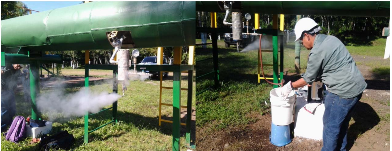
Figura 8. Muestreo de agua usando un separador Webre en la línea bifásica del pozo AH-16A en la Central Geotérmica Ahuachapán - El Salvador.
