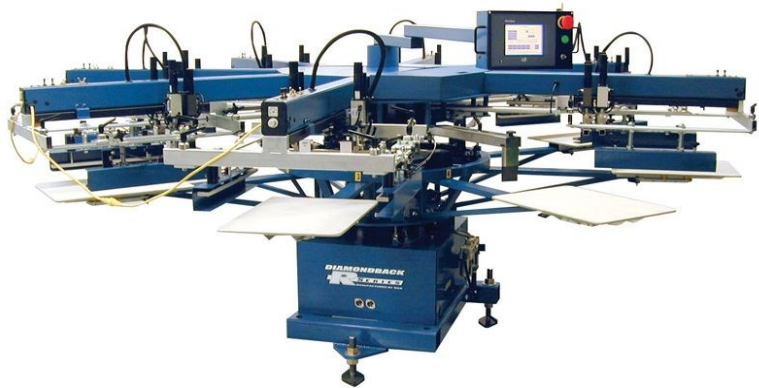
Img 05. Pulpo automático de 5 estaciones y 5 colores.
