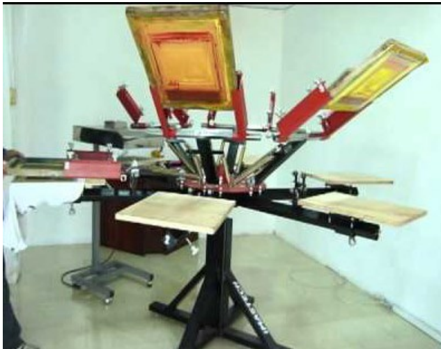
Img. 37 Montaje del marco revelado y seco, listo para estampar sobre tela. Fotografía: Josue Beltrán
