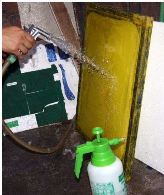
Img. 36 Aplicación de agua al marco revelado para retirar la emulsión Fotografía: Josue Beltrán
