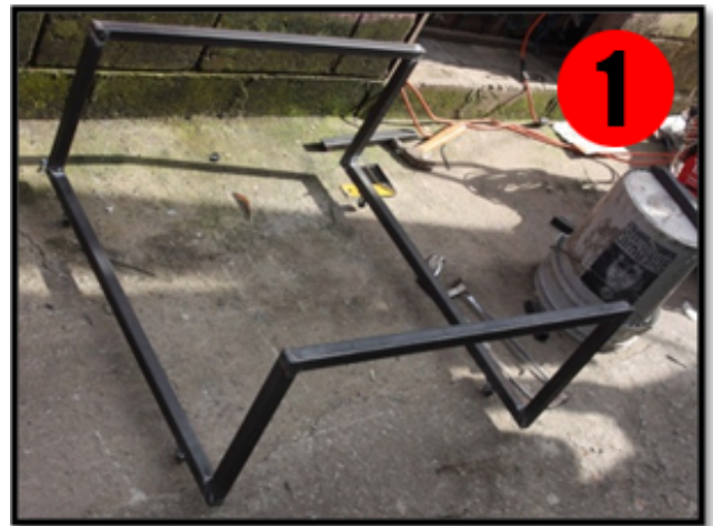
Img. 18: Estructura que sostendrá el horno Tomada: Josué Beltrán Robles. 23/08/2011
