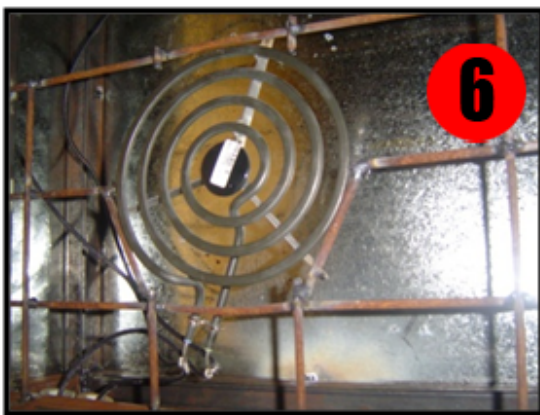
Img 23 y 24 Forma de las rejillas soldada a las hornillas que dan el calor a las piezas textiles
