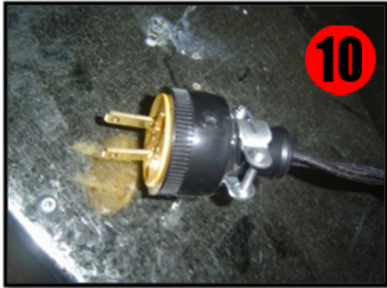
Img. 27 Tomacorriente de dos polos para la conexión eléctrica del horno.
