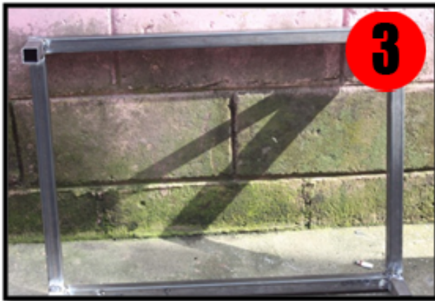
Img. 20 Estructura interna del horno Fotografía: Josue Beltrán. 23/08/2011.
