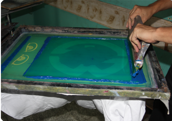
Img 03. Forma de transferencia de tinta a través de un marco emulsionado.
