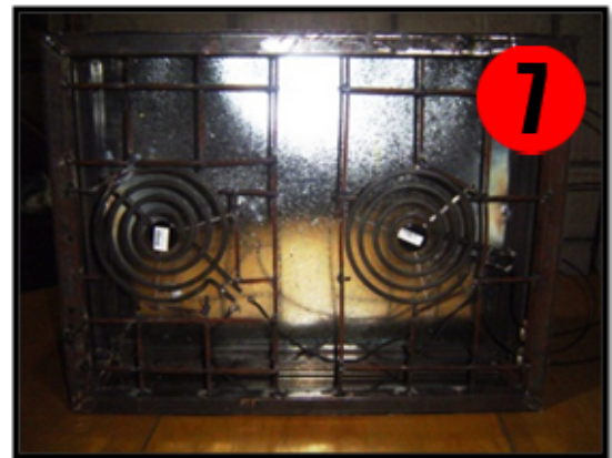
Img 23 y 24 Forma de las rejillas soldada a las hornillas que dan el calor a las piezas textiles
