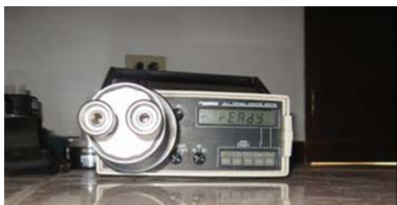
Figura 5. Monitor de Radiación Portátil modelo Pylon AB-5 y una Celda de Lucas modelo Pylon 300A (celda de centelleo).
