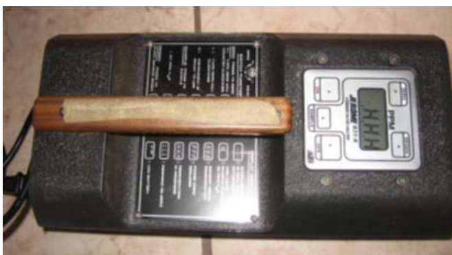
Figura 6. Analizador de Sulfuro de Hidrógeno Arizona modelo Jerome 631-X.
