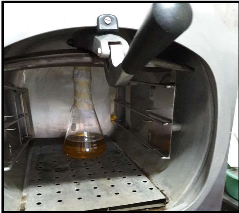
Figura 17. Esterilización del medio Agar Base Sangre en autoclave.
