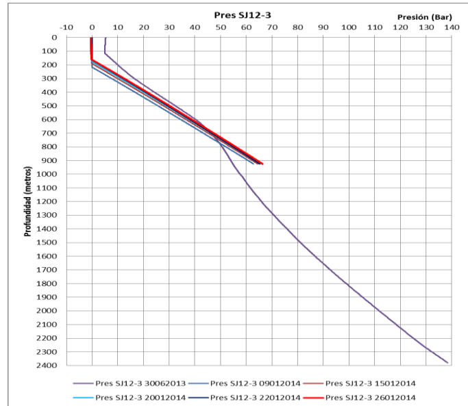
Figura 40. Perfil de presión estática pozo SJ12-3
