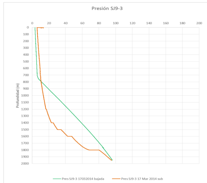
Figura 27. Perfil de presión dinámica pozo SJ9-3
