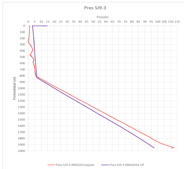
Figura 20. Perfil de presión dinámico pozo SJ9-3
