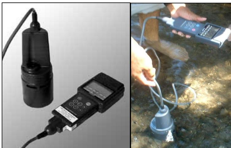
Ilustración A-4 HORIBA U-10 Se muestra la forma de uso del equipo utilizado para mediciones realizadas
