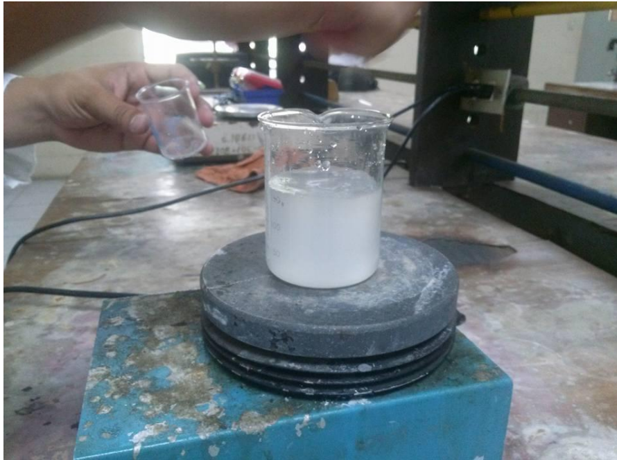
g) Adición de solución de Almidón a la muestra de agua servida que contiene Sulfato de Aluminio. Proceso con agitación magnética.
