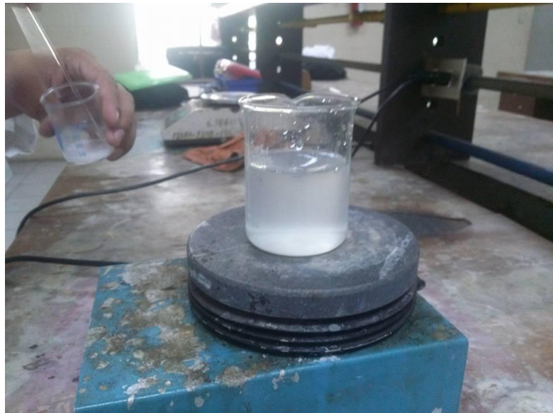
f) Adición de Solución de Sulfato de Aluminio a la muestra de agua servida. Dicho procedimiento con agitación Magnética.
