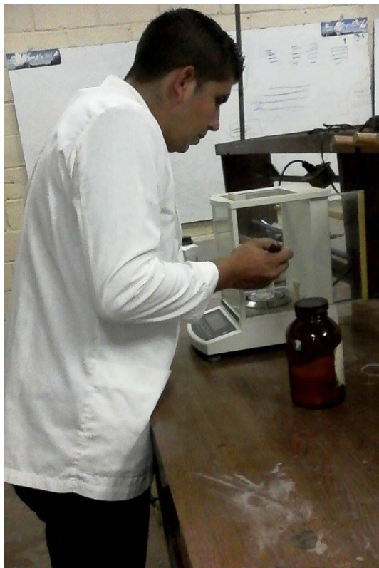
b) Preparación de la solución de Sulfato de Aluminio
