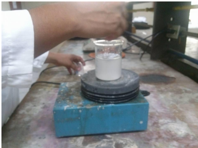
h) Agitación de la muestra de agua residual conteniendo el Coagulante y Floculante
